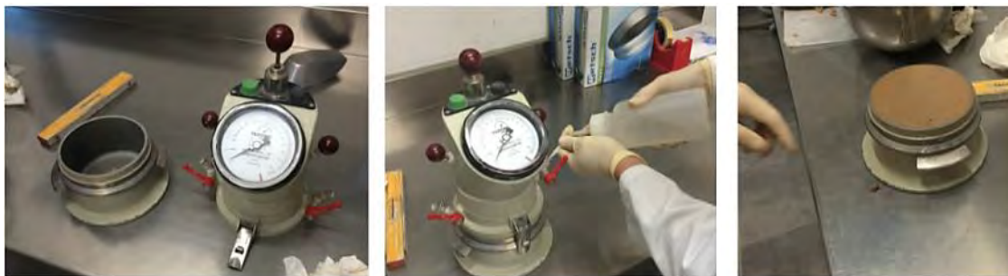
Figura 116- Valutazione del contenuto di aria
