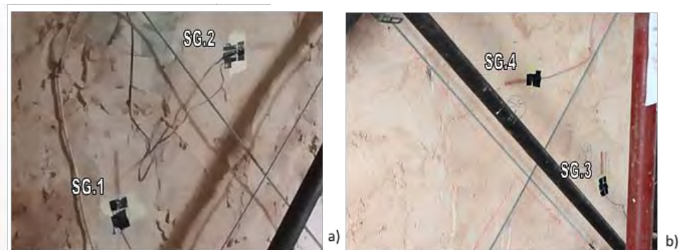
Figura 136 – Disposizione degli strain gauges campione 2: a) lato A; b) lato B
