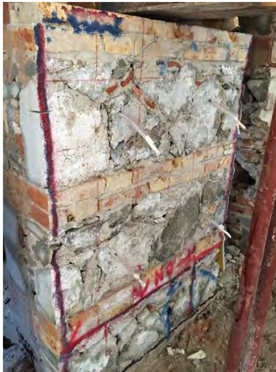
Figura 107 – Posizionamento dei connettori metallici sul campione 2
