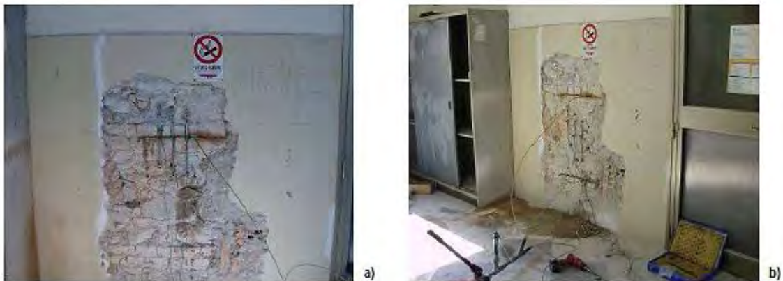
Figura 100 – Prova con martinetti piatti campione 8: a) singolo, b) doppio
