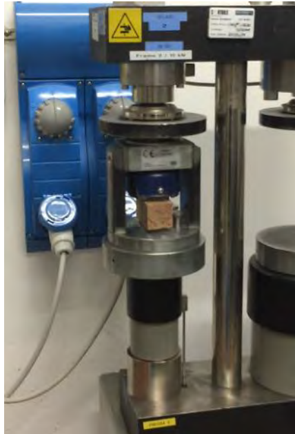
Figura 119 – Macchinario per la realizzazione della prova a compressione
