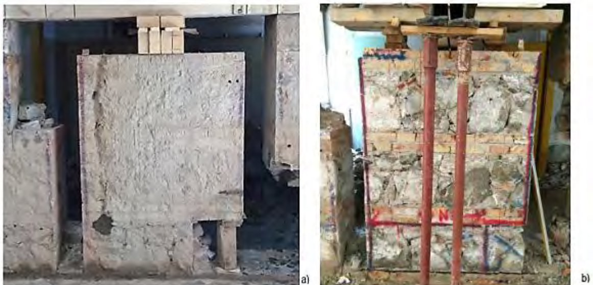
Figura 105 – Taglio dei muri; a) campione 1, b) campione 2
