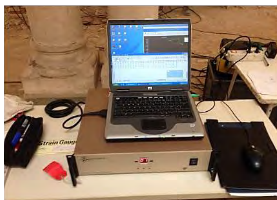
Figura 125 – Sistema di misurazione delle tensioni: a) System P5000 ; b) Estensimetro TML – PL-60-11
