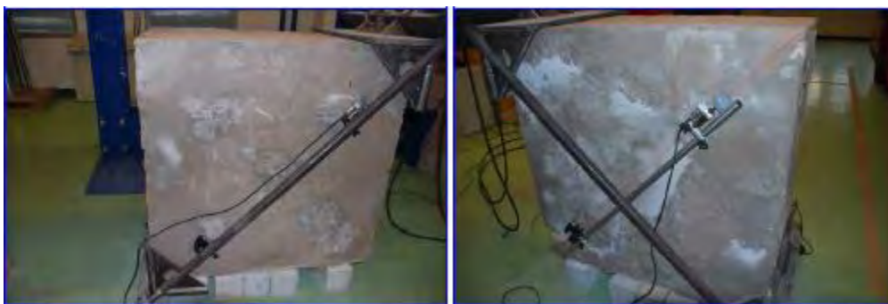
Figura 24– Strumentazione necessaria per l'esecuzione della prova
