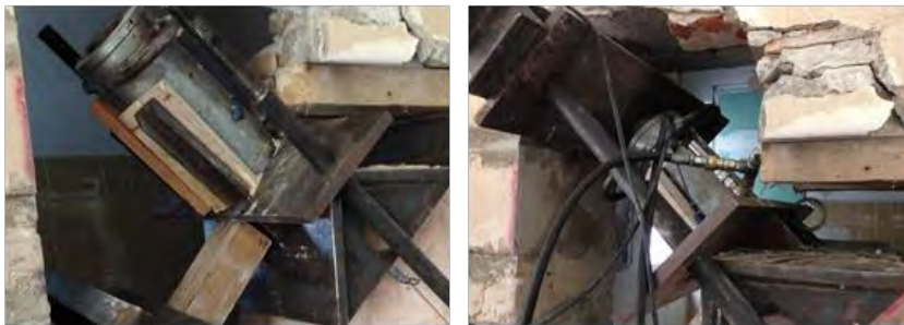
Figura 121 – Martinetto oleodinamico e punto di applicazione del carico
