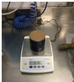
Figura 115 - Determinazione della massa volumica
