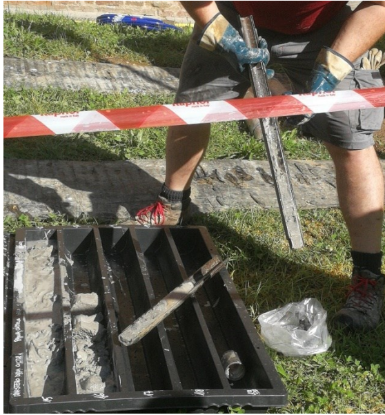
Figura 2.4. Punta cava utilizzata nella prova S.P.T. per l'estrazione dei campioni di terreno
