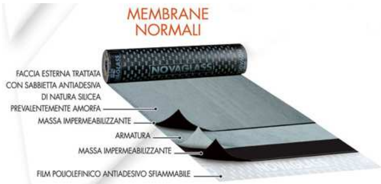
Figura 2.1 La membrana bitume – polimero nei suoi componenti principali e complementari
