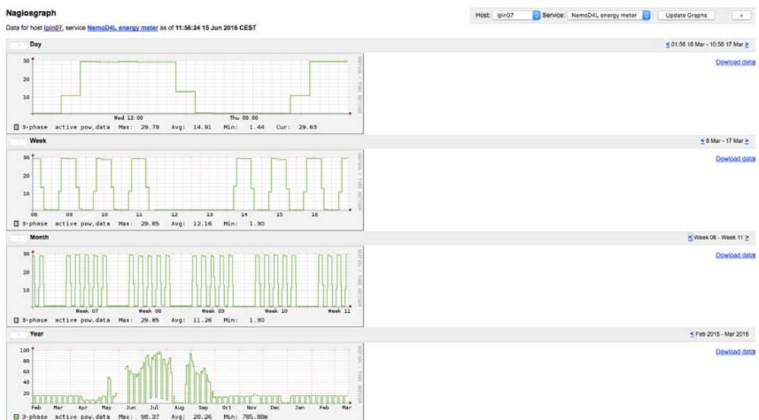
Figura 3.9 Andamento de consumo nei giorni 16 e 17 marzo dell'impianto di condizionamento asservito alla parte aule dell'edificio DEI/G
