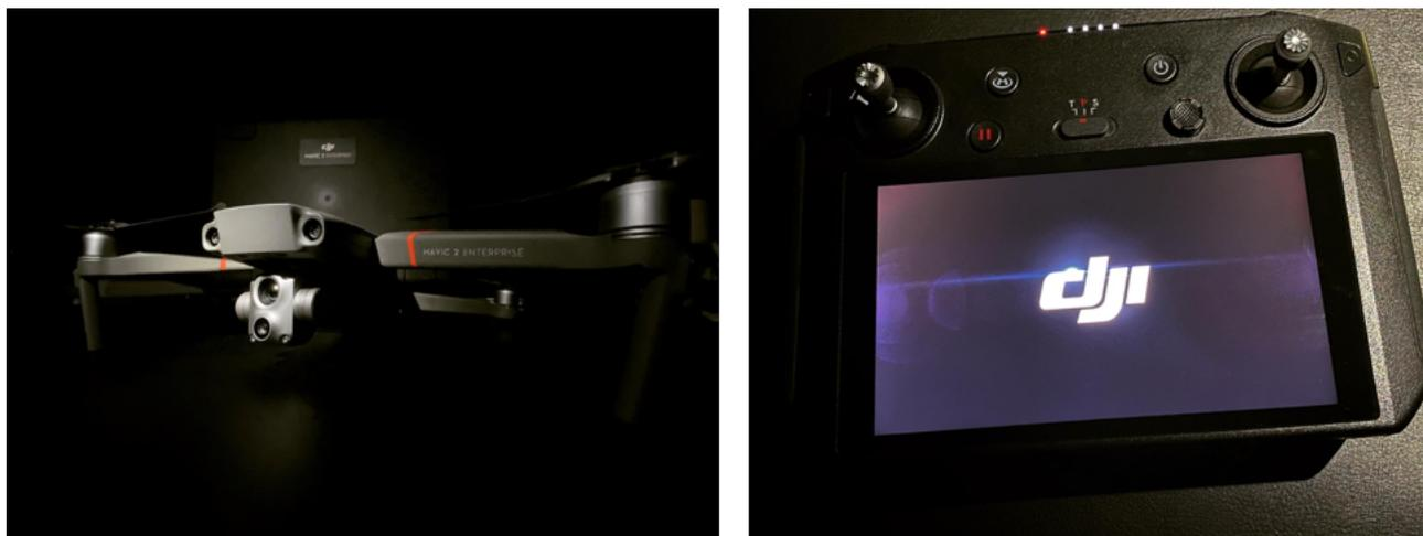
Figura 8. Equipaggiamento per il monitoraggio in a) DJI Mavic 2 Enterprise Advanced utilizzato e b) radiocomando.
