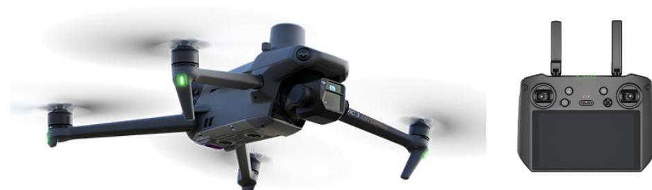
Figura 9. Equipaggiamento per il monitoraggio in a) DJI Mavic 3 Enterprise utilizzato e b) radiocomando
