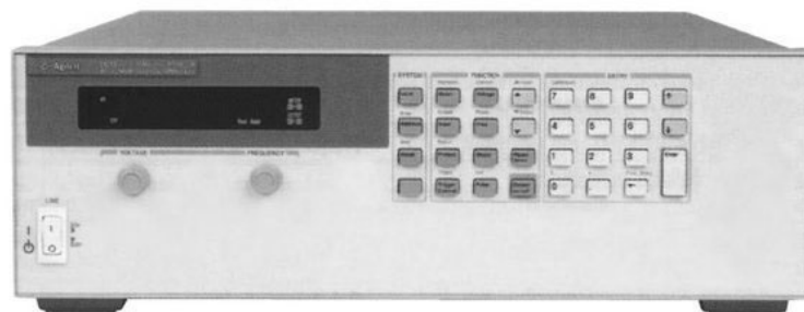
Figura 6.4 – Generatore di segnali 6812B
