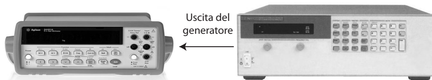
Figura 6.2 – Banco di misura per la caratterizzazione del generatore di segnali
