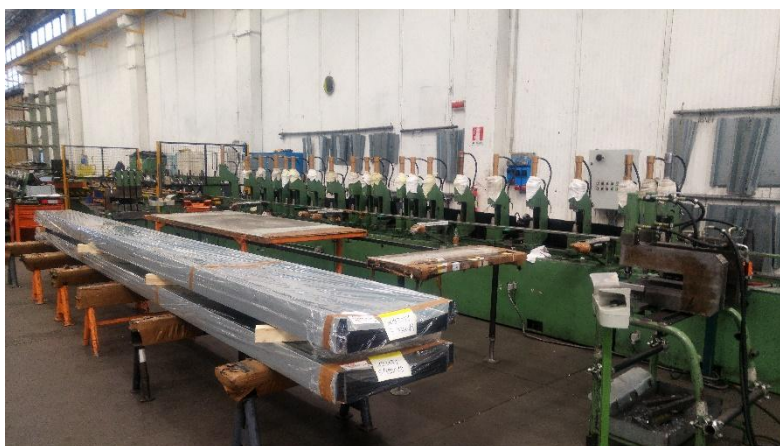
Figura 4.14: Profila per realizzare greche e foratura degli spicchi
