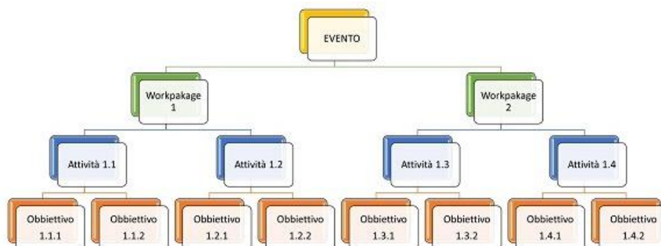
Figura 2.7: Esempio di Work Breakdown Structure.
