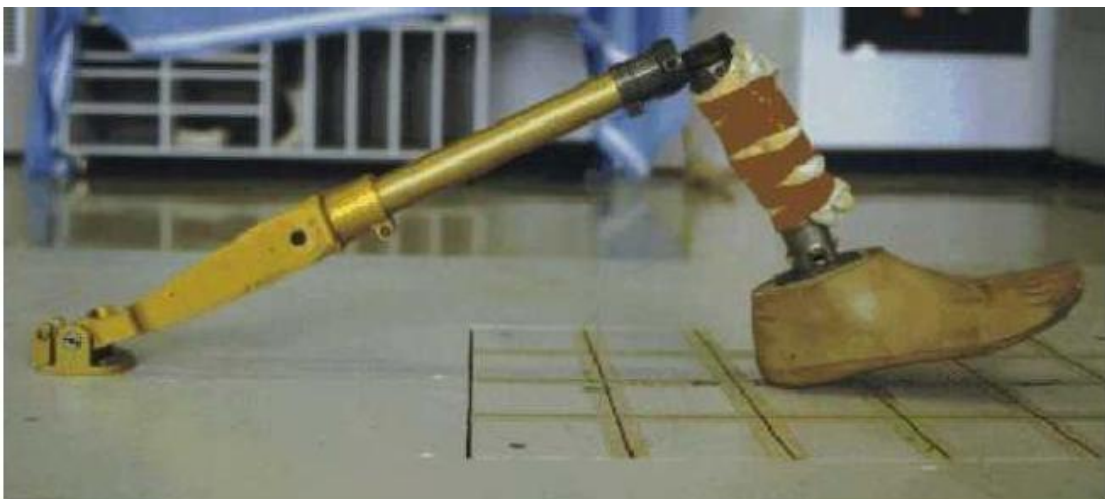
Figura 21: Pendolo e piattaforma d'acciaio, usati per il test da impatto.
