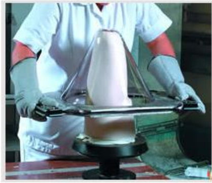
Figura 11: il tecnico ortopedico mentre adagia il Nortplex® estratto dal forno, su un gesso di un moncone amputato a livello femorale.
