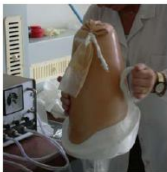
Figura 12: il tecnico ortopedico mentre fa scorrere la resina all'interno dei sacchi di PVA.
