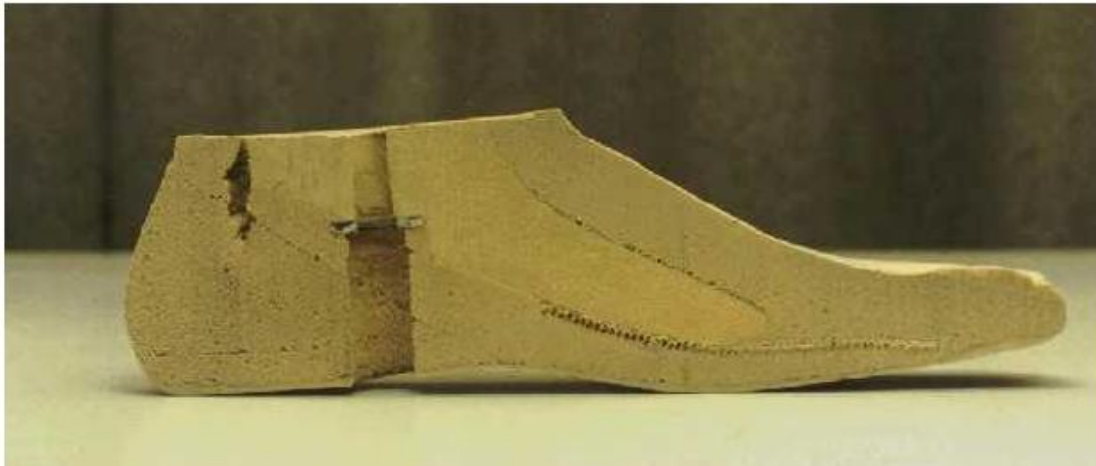
Figura 25: Piede Kingsley sezione sagittale dopo 10.000 cicli.
