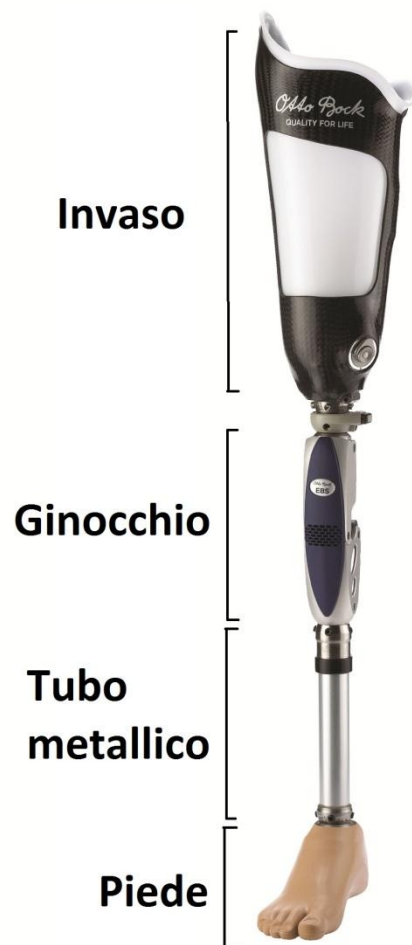
Figura 6: Schematizzazione delle parti di una protesi endoscheletrica.
