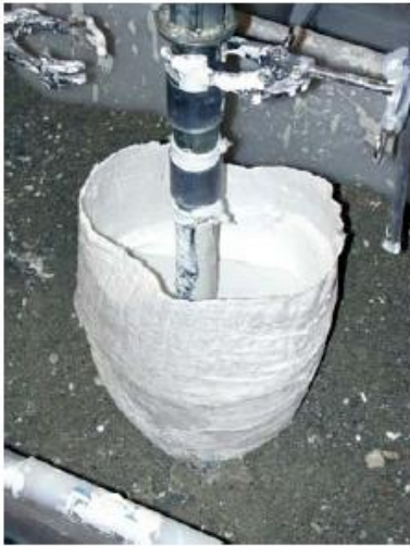
Figura 9: colata di gesso all'interno delle bende gessate.
