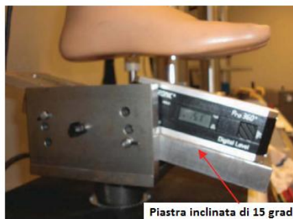
Figura 20: Strumentazione per l'esecuzione della prova statica
