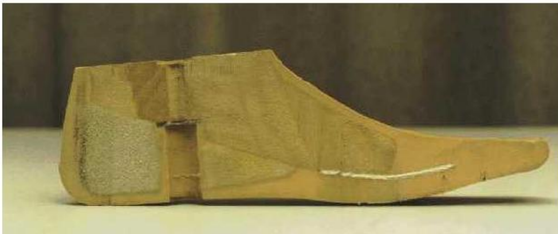
Figura 23: Piede Otto Bock dopo 200.000 cicli. Sezione sagittale.
