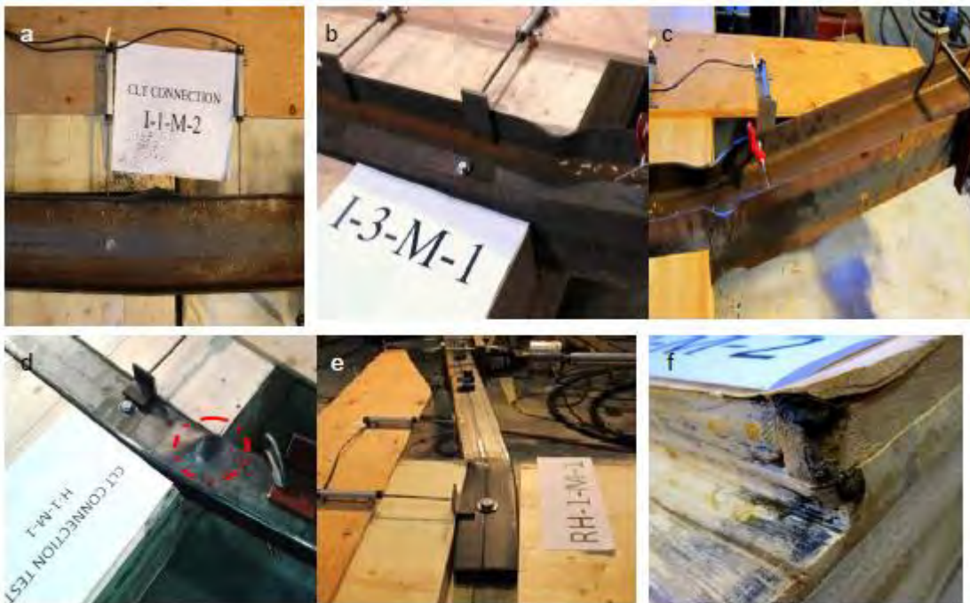
Figura 2.34: Risultati dei test dopo le prove monotone. A) deformazione serie 1; b) deformazione serie 2; c) deformazione serie 3; d) deformazione serie 4; e) deformazione serie 5; f) danneggiamento pannello ligneo serie 5. Immagine tratta da "Experimental and numerical investigation of novel steel-timber-hybrid system" Pooja Bhat et al. 2014.
