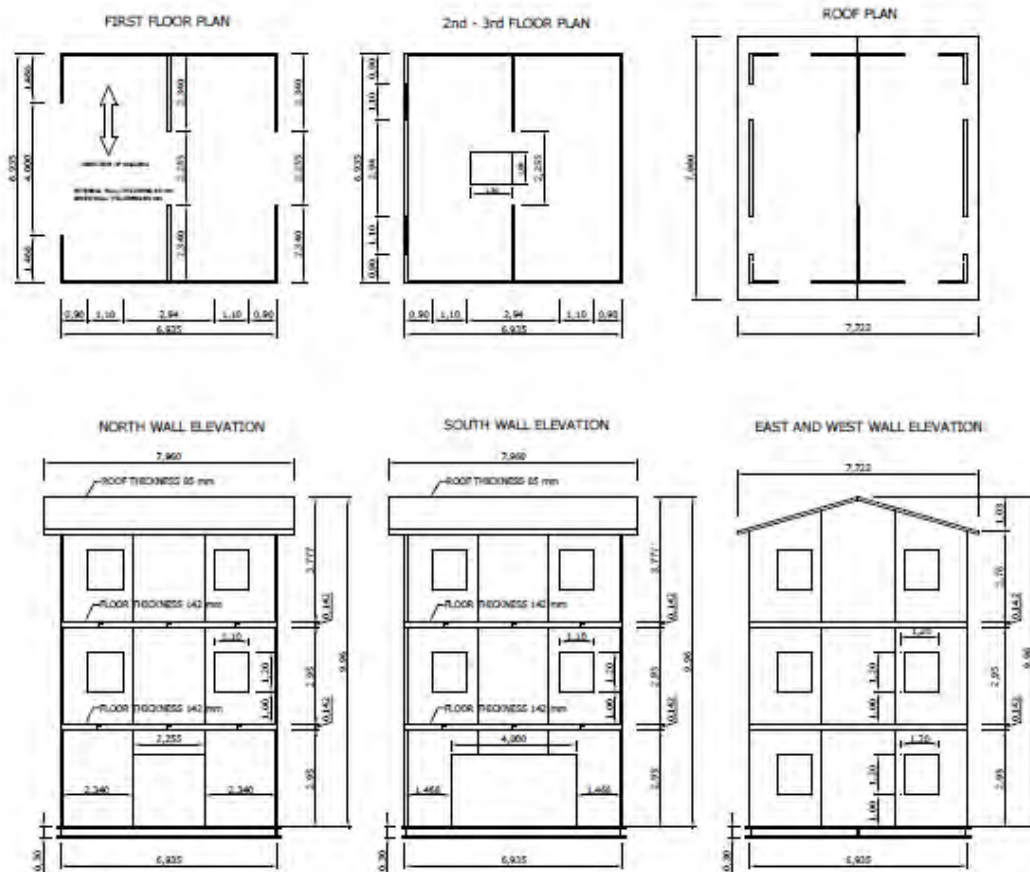
Figura 2.2: Pianta e prospetti dell'edificio a 3 piani configurazione C. Immagine tratta da "Comportamento sismico di edifici in X-Lam: il progetto SOFIE" Ario Ceccotti.
