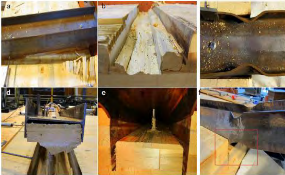
Figura 2.35: Risultati dei test dopo le prove cicliche. Immagine tratta da “Experimental and numerical investigation of novel steel-timber-hybrid system” Pooja Bhat et al. 2014
