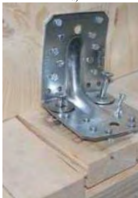
Figura 4.68: Rotture fragili angolari. Immagini tratte da dispensa lezioni e da “Capacity seismic design of X-Lam wall systems based on connection mechanical properties” Gavric et al. 2013.
