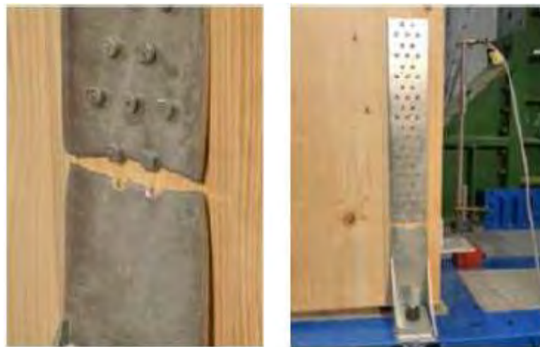
Figura 2.1: Modalità di rottura per hold-down, tranciamento della lama di acciaio.
