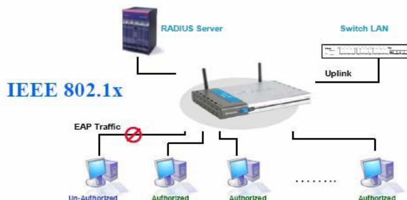
Figura 3-7: Struttura di una wlan con server Radius
