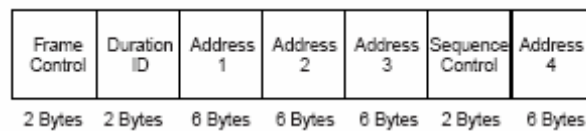
Figura 2-8: Formato di un frame 802.11 e del MAC header
