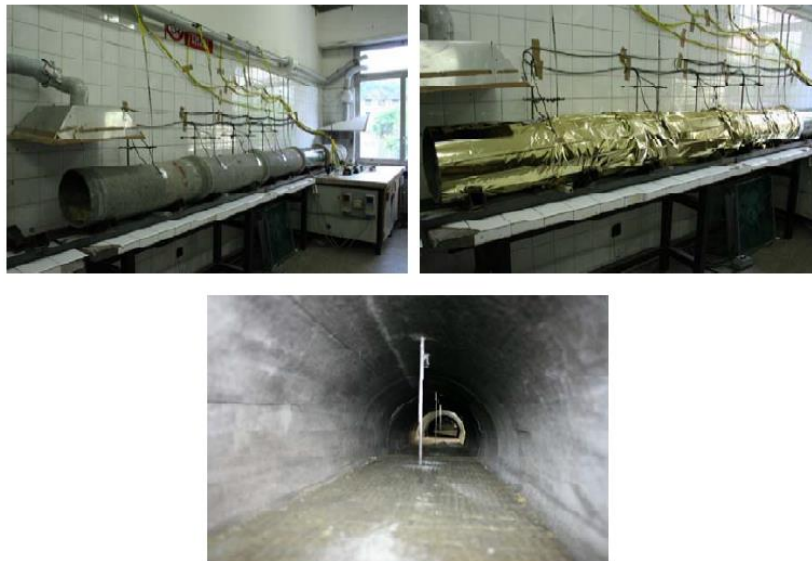
Figura 4.3: Sistema di termocoppie per il prelievo dei dati termici
