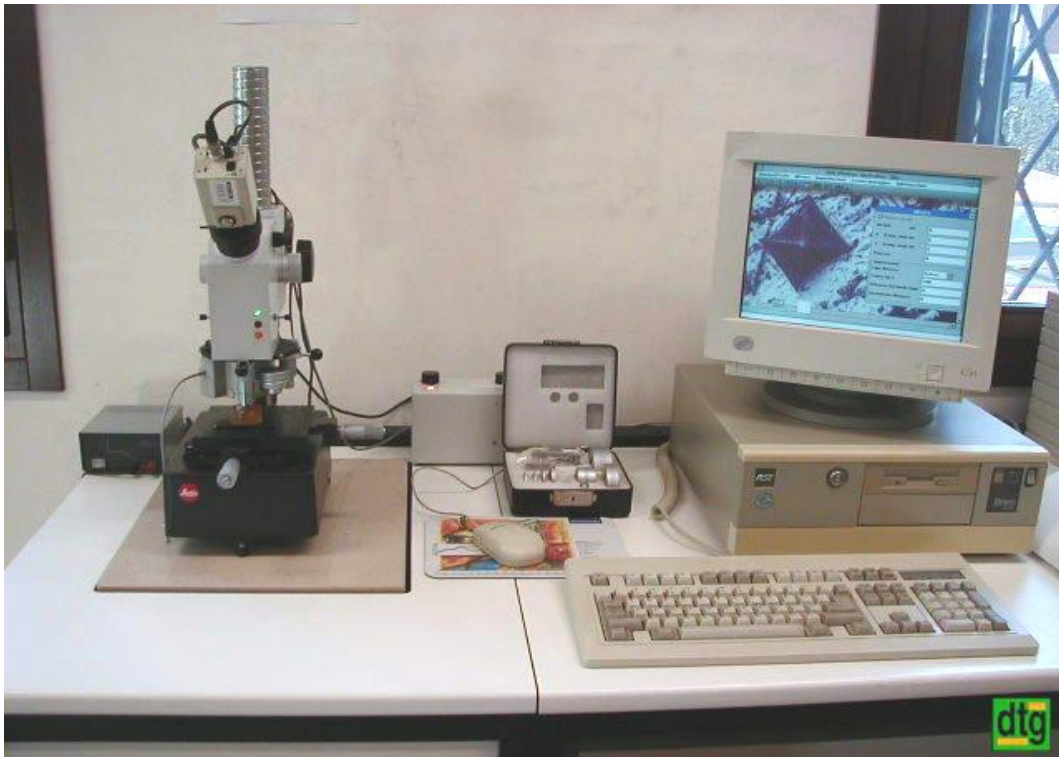
Figura 2.9: microdurometro utilizzato in laboratorio per la determinazione dei profili di durezza
