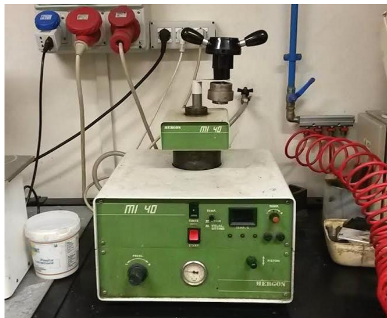
Figura 2.6: inglobatrice metallografica utilizzata in laboratorio
