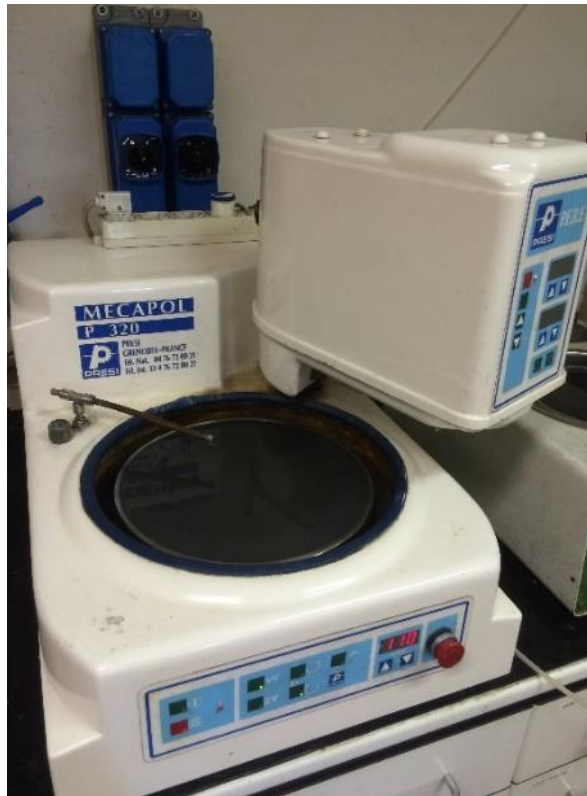
Figura 2.7: lappatrice utilizzata in laboratorio per la sgrossatura e finitura dei provini
