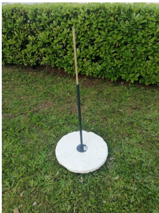
Figura 22: immagine raffigurante l'erbometro, strumento utile alla misura dell'altezza e della produttività dell'erba.
