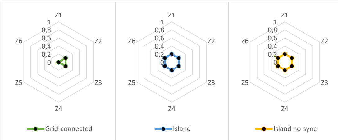
Fig. 6.31 - Comportamento con guasti alla sbarra
