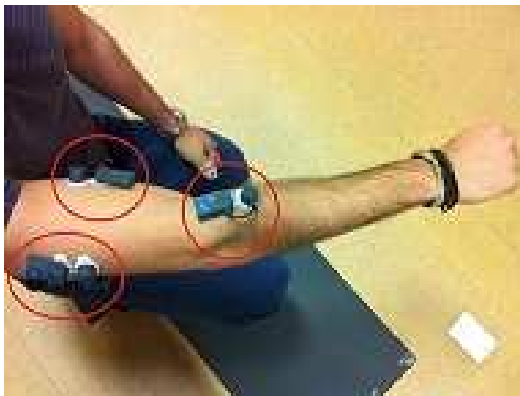
Figura 4.12: Siti di applicazione elettrodi sEMG su paziente per la prova sperimentale.
