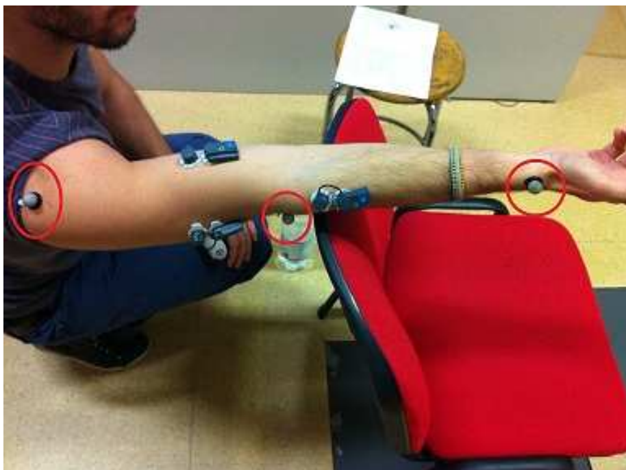
Figura 3.17: Marcatori usati per la registrazione del movimento di flessione-estensione del gomito, collocati sui punti di repere anatomici decisi precedentemente.
