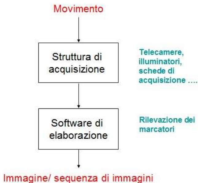
Figura 3.14: Architettura del sistema di acquisizione della fotogrammetria
