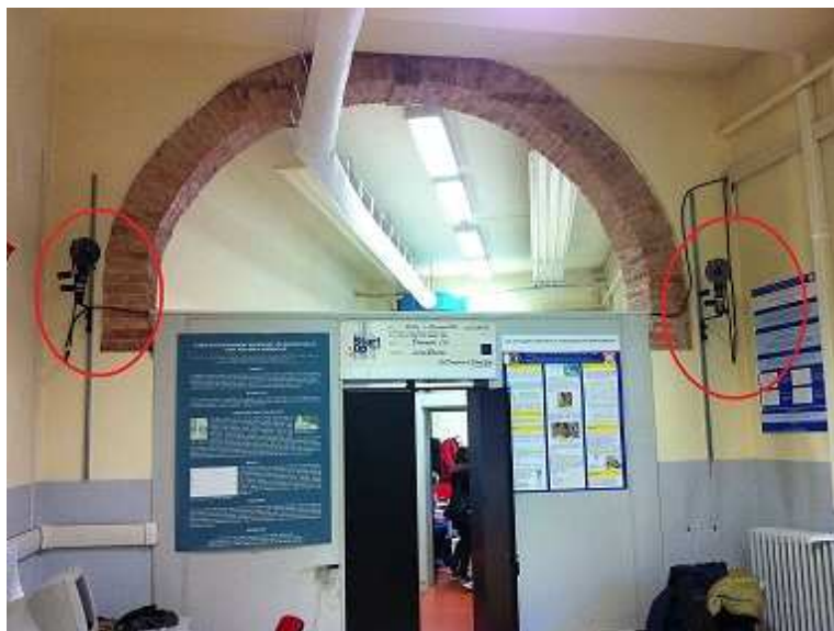
Figura 3.16: Telecamere usate per la stereofotogrammetria, registrazione del movimento.
