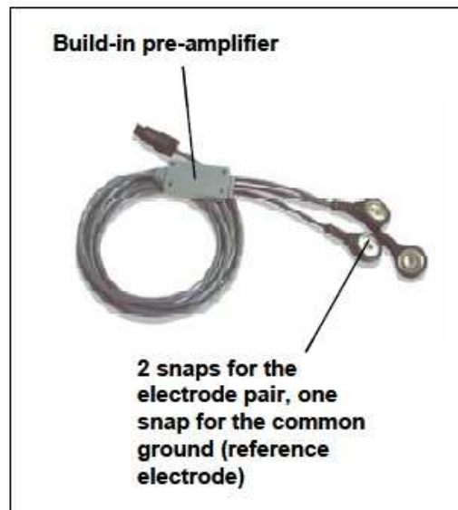
Figura 2.9: Pre-amplificatori direttamente incorporati nei cavi.
