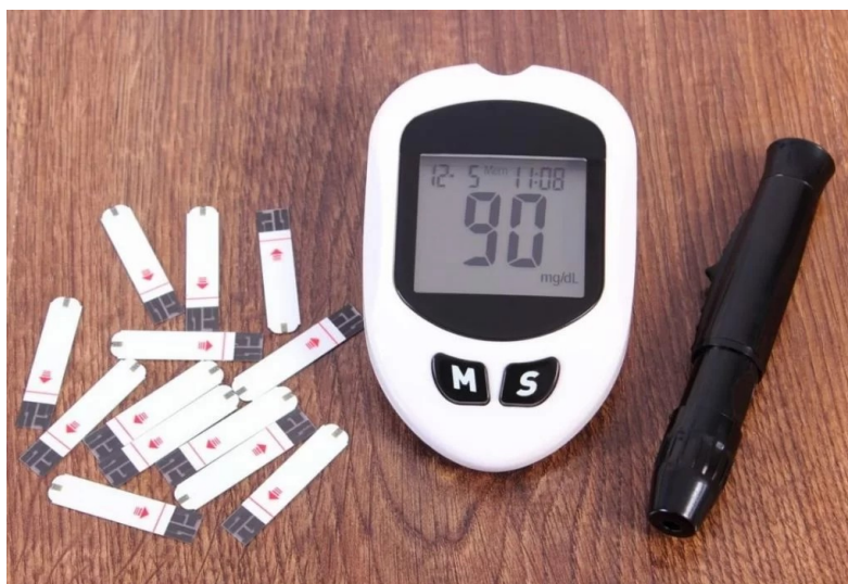
Figura 1.1 (presa da [1s]): A sinistra le strips utilizzate per ricevere il sangue, al centro il glucometro che misura la glicemia e a destra il pungidito per prelevare una goccia di sangue.
