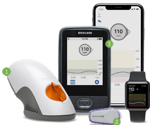
Figura 1.2 (presa da [2s]) - CGM Dexcom G6 composto da: (1) applicatore automatico per poter inserire un piccolo sensore al di sotto della cute; (2) sensore e trasmittente; (3) dispositivo di visualizzazione.
