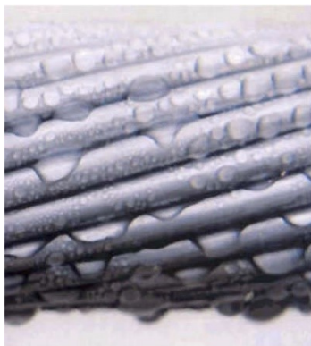
Figura 2.8: Condizione di idrofobicità di un conduttore
