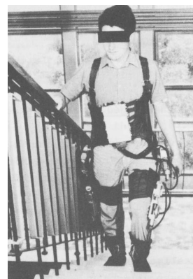
Figura 1.2: Paziente con un esoscheletro azionato elettricamente.
