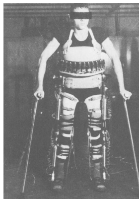
Figura 1.1: Paziente con un esoscheletro pneumatico dotato di tronco.
