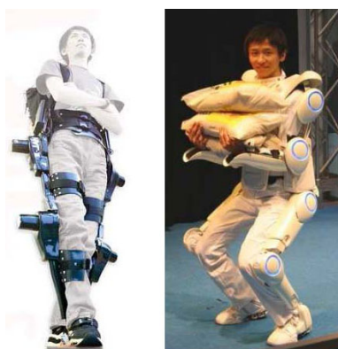
Figura 1.6: Hybrid Assistive Leg (HAL): versione 3 (sinistra) e versione 5 (destra).
