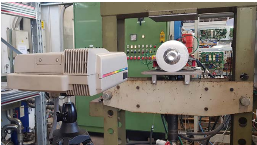
figura 5.5 - misura termica del carico
