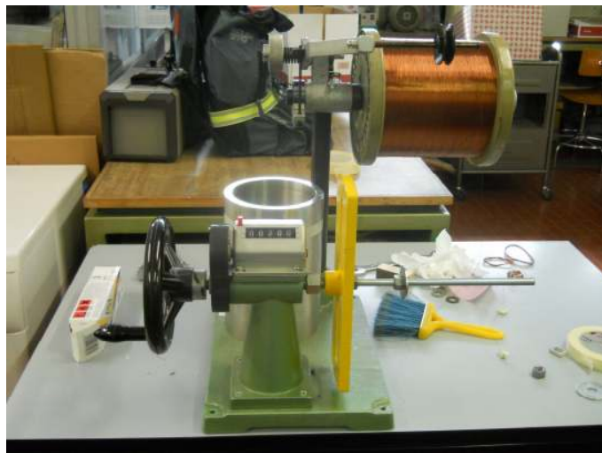
Fig. 3.3: Avvolgitrice utilizzata per la costruzione degli avvolgimenti
