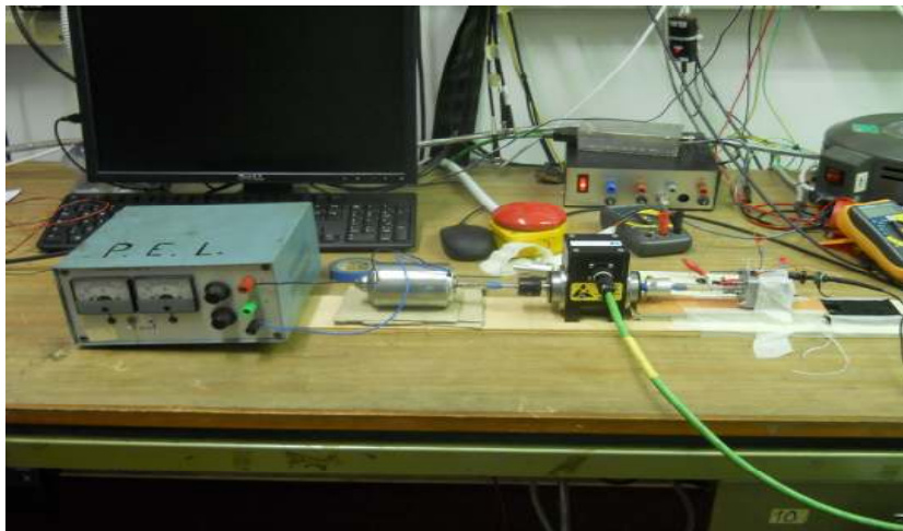
Fig. 5.11: Misura della coppia a vuoto mediante torsionometro meccanico
