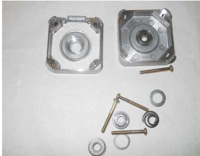
Fig. 3.6: Componenti necessari al montaggio della carcassa metallica
