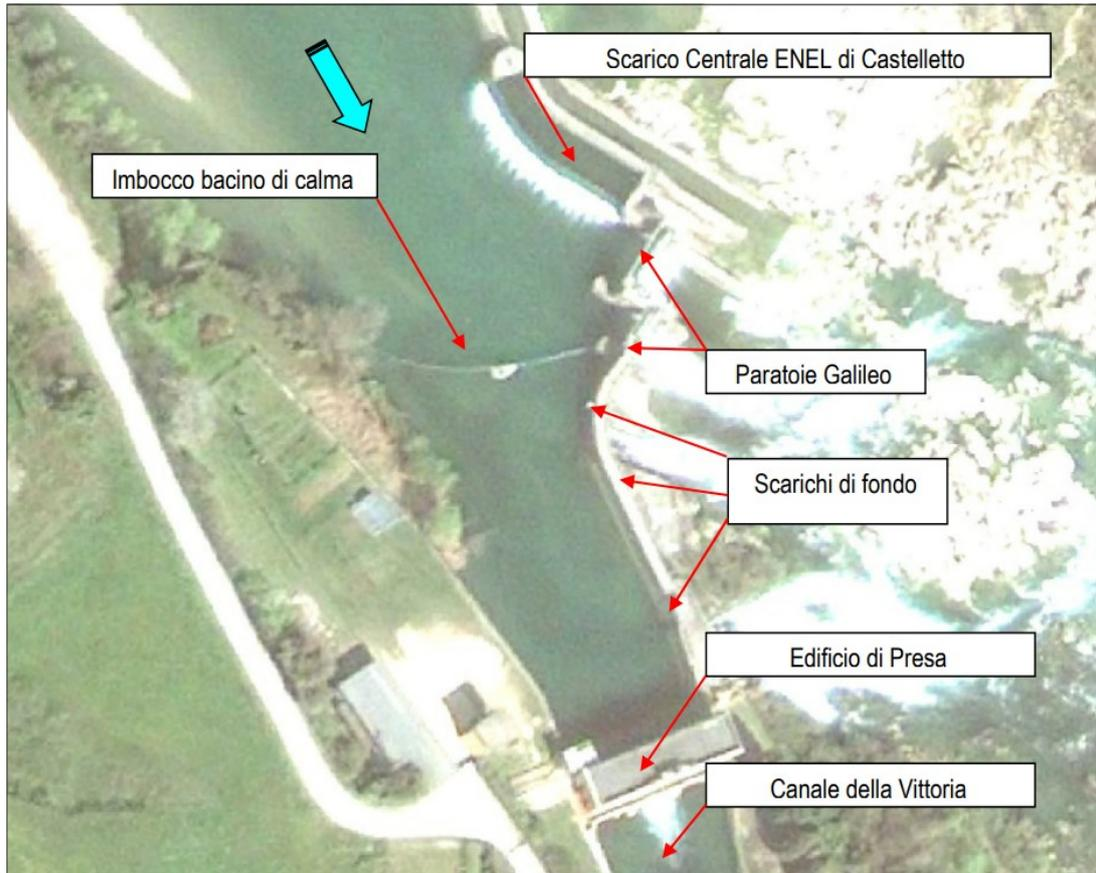
**Figura 17.** Configurazione dell'opera di presa prima della costruzione della centrale
