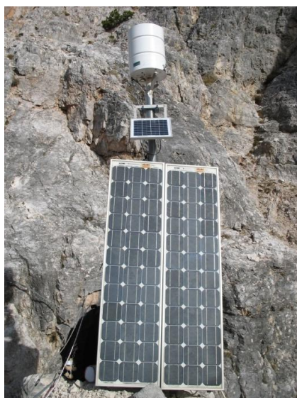
Fig. 3.4 - Il pluviometro a basculante di monte, 22 settembre 2017
