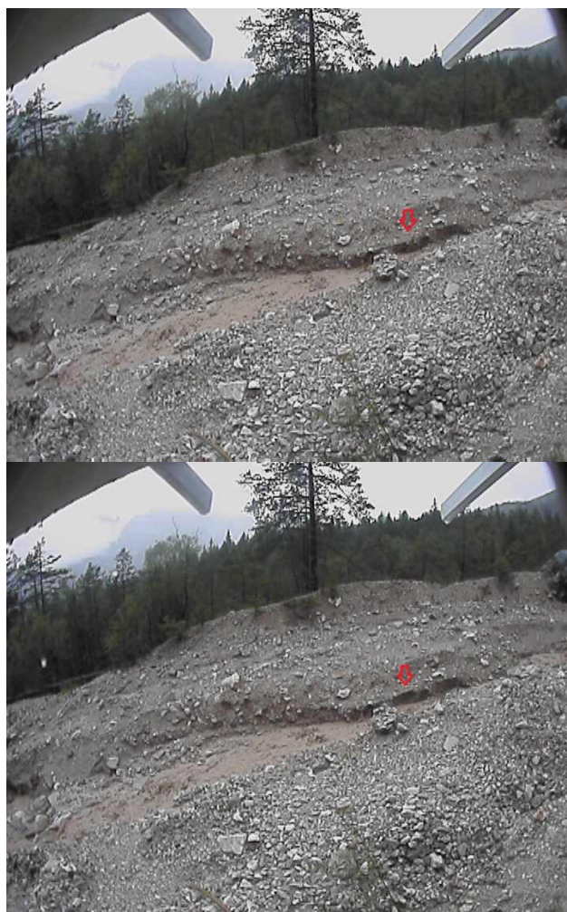
Fig. 5.6 - Azione erosiva dello scorrimento superficiale nell'Evento 11.
