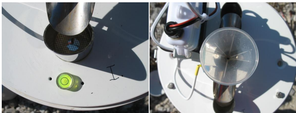
Fig. 4.1 - Stato della bolla sferica e dell'imbuto interno nel pluviometro intermedio durante la verifica della strumentazione, 22 settembre 2017
