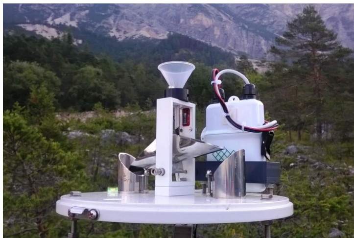
Fig. 3.6 - Dettaglio del pluviometro a basculante di valle, 4 agosto 2017
