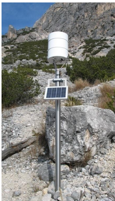
Fig. 3.5 - Il pluviometro a basculante intermedio, 22 settembre 2017
