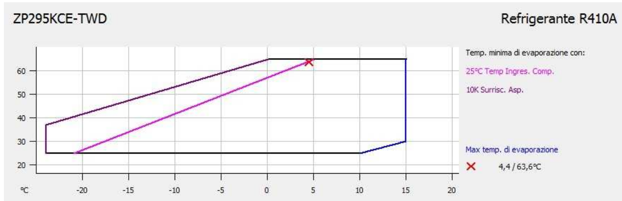
Figura 8-3: Punto di funzionamento del compressore (molto prossimo al confine del campo operativo)
