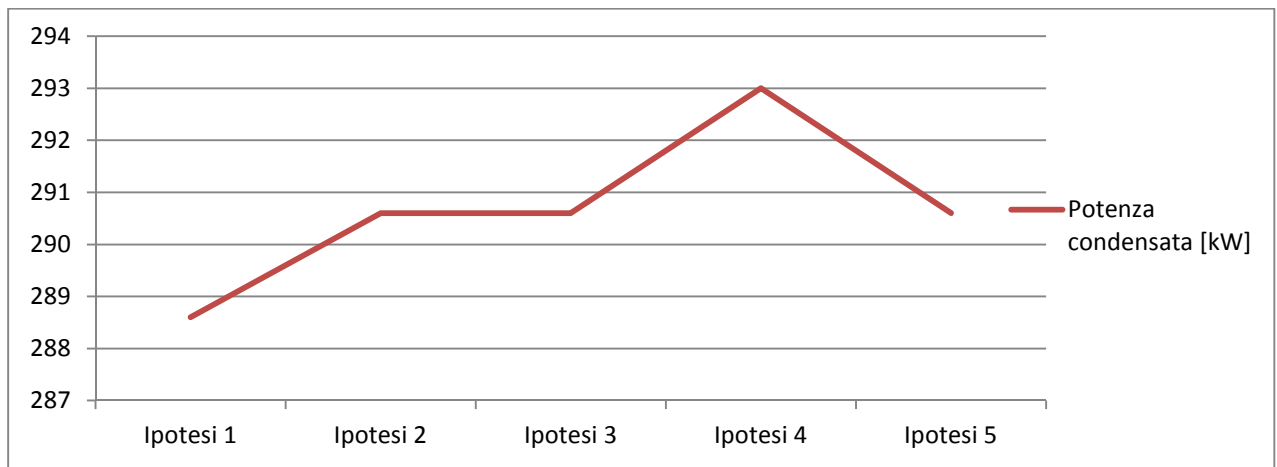
Figura 6-16: Potenza termica nel funzionamento in pompa di calore: confronto tra le ipotesi.
