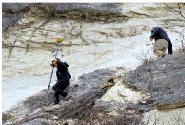
Fig.27 Rilievo delle coordinate gps dei target. Fonte NEOSS s.r.l
