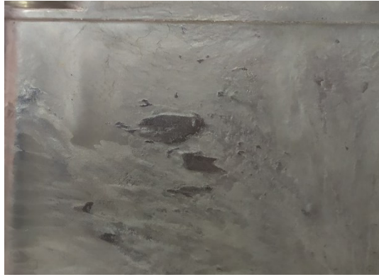
Figura 2.11 – Esempio di contaminazione sul getto di riferimento per la tesi.
