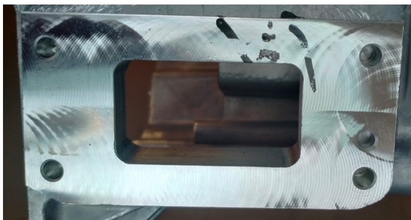
Figura 7.18 – Porosità visibile in zona 3 del campione scartato al controllo visivo.
