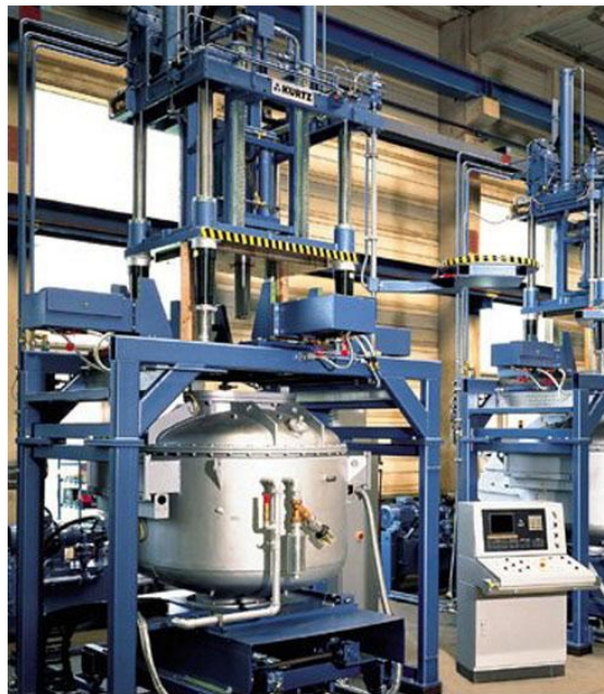
Figura 2.2 – Macchina per il processo di Low Pressure Die Casting [8].
