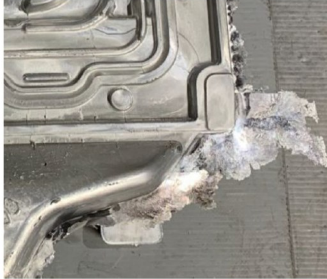
Figura 2.15 – Esempio di bava su getto di riferimento.
