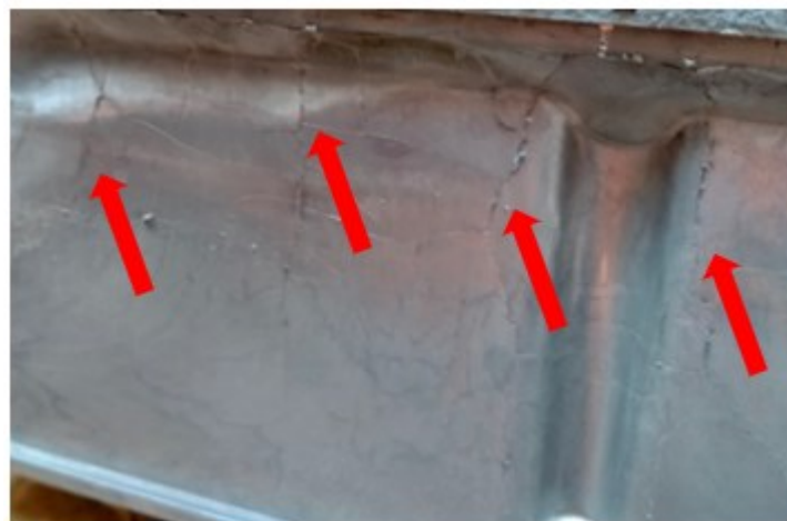
Figura 2.12 – Esempio di segni di fatica termica su getto di riferimento.
