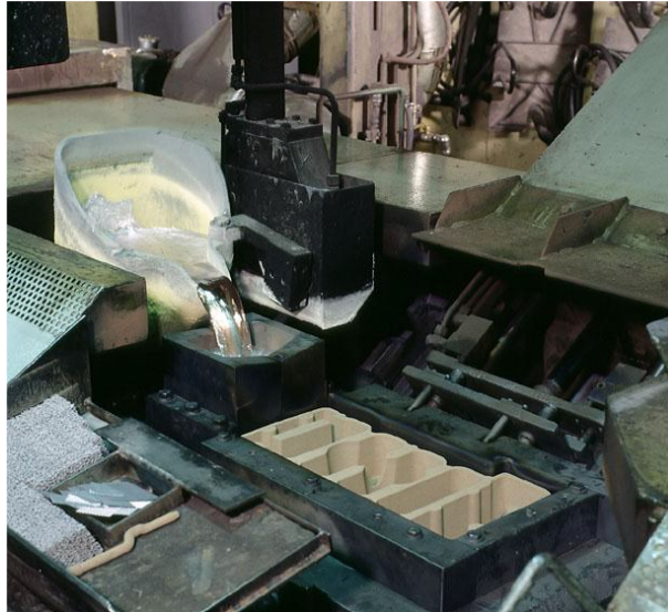
Figura 2.1 – Processo di Gravity die casting, fase di riempimento dello stampo con la lega fusa [8].
