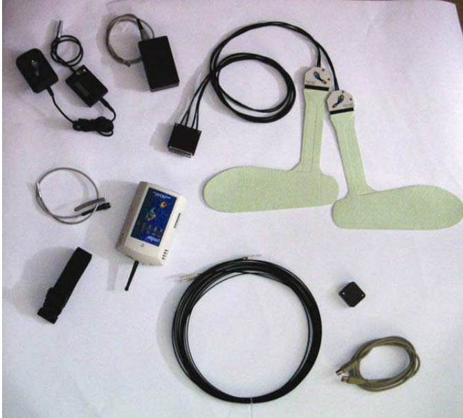
Figura 3.1. componenti del sistema Pedar
