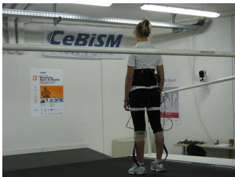
Figura 3.7. prova in statica su treadmill indossando solette Pedar
