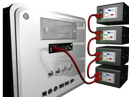
Figura 2.12: Connessione di una catena di telecamere all'HUB/Server
