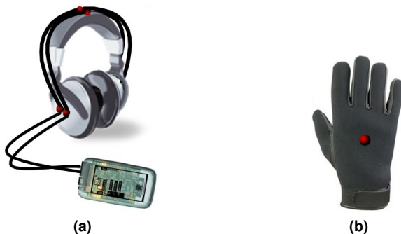
Figura 4.1: Cuffie con sensori connesse alla LED Driver Unit (a) e il guanto con il sensore associato alla sorgente (b)
