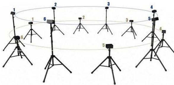
Figura 2.13: Esempio di posizionamento delle telecamere per il full-body tracking
