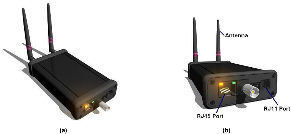
Figura 2.4: La LED Base Station (a) e le interfacce di cui dispone (b)
