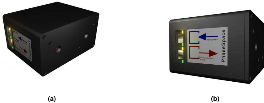
Figura 2.10: Le telecamere: i sensori frontali (a) e le porte Ethernet (b)
