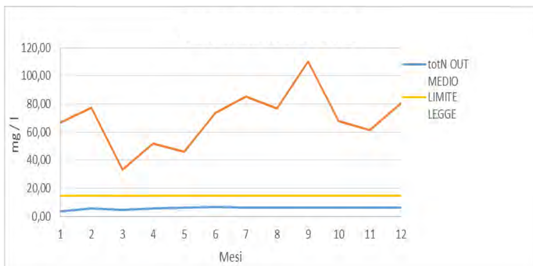
Figura 4.9 – Andamento della concentrazione dell'azoto totale in ingresso e in uscita.
