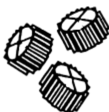
Figura 5.2 – Corpi di riempimento KALDNES tipo K1
