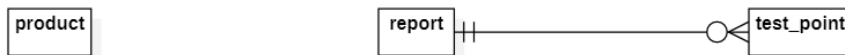
Figura 3.7: Risultato dell'analisi delle strutture del dominio, ovvero una relazione 1:N tra report e test_point . Si tratta di una relazione di aggregazione, poiché i risultati dei test sono contenuti in un report .
