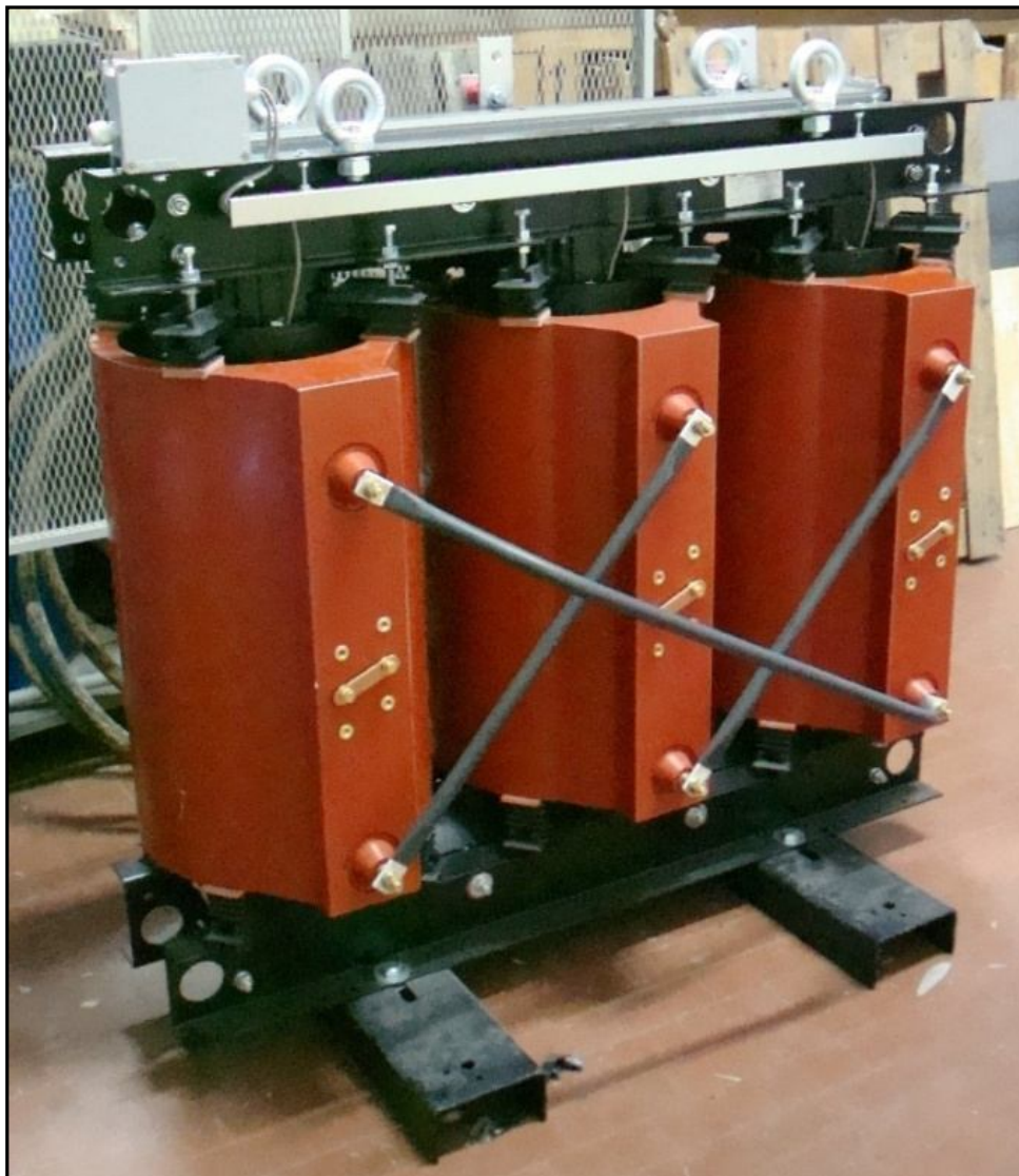
Figura 8.4(2): Trasformatore trifase EUROELETTRO da 315 kVA. Fonte: Archivio personale foto per tesi di laurea specialistica – Bottega Luca
