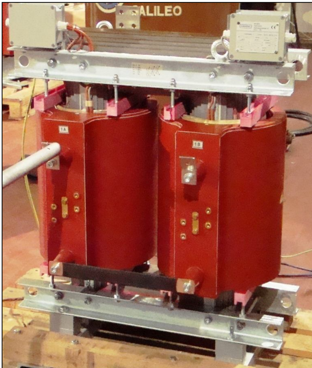
Figura 8.2(2): Trasformatore monofase Amadori da 220 kVA inserito nel circuito di prova delle scariche parziali nel quale si riesce a notare come le zeppe superiori ed inferiori servano al sostegno ed al bloccaggio sia per le bobine primarie esterne che per le bobine secondarie interne.
