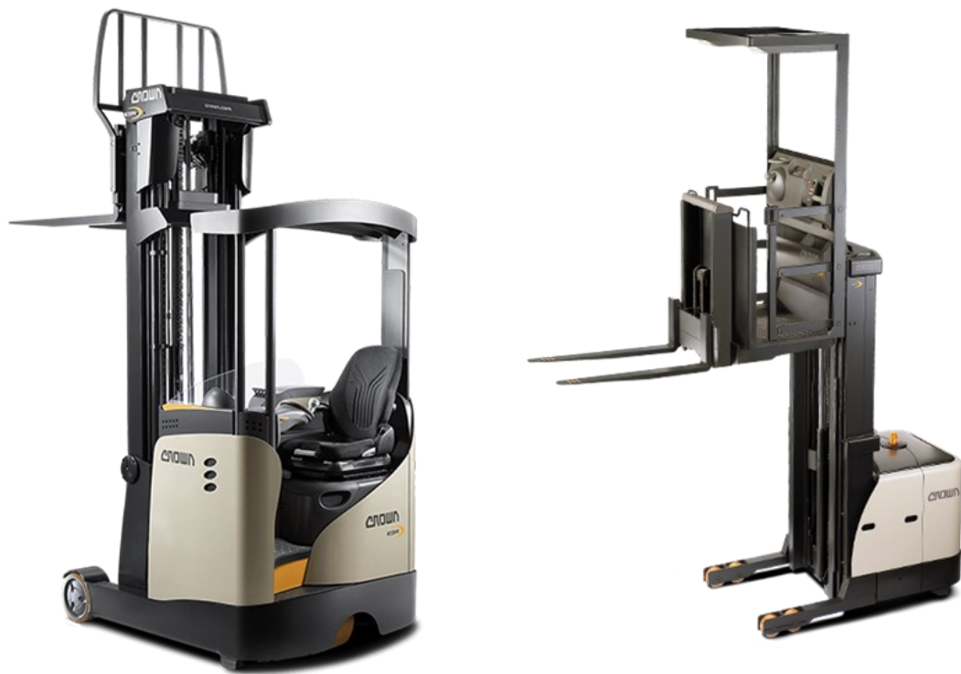
Figura 2.4: Esempi di carrelli elevatori impiegati nelle operazioni di magazzino: a sinistra, un esempio di carrello retrattile e a destra un esempio di commissionatore.
