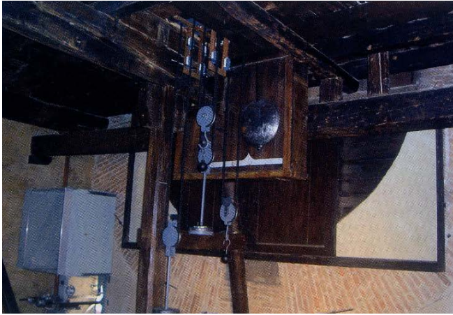
Figura 5. Pulegge e pesi dell'orologio
