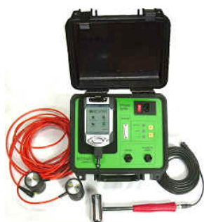
Figura 39. Strumentazione per eseguire la prova sonora
