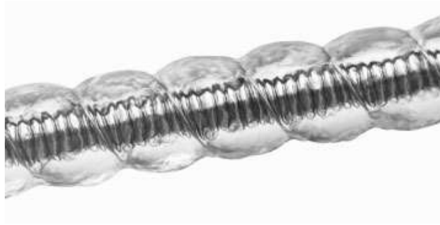
Figura 3.15: Bobina in platino rivestita da idrogel.
