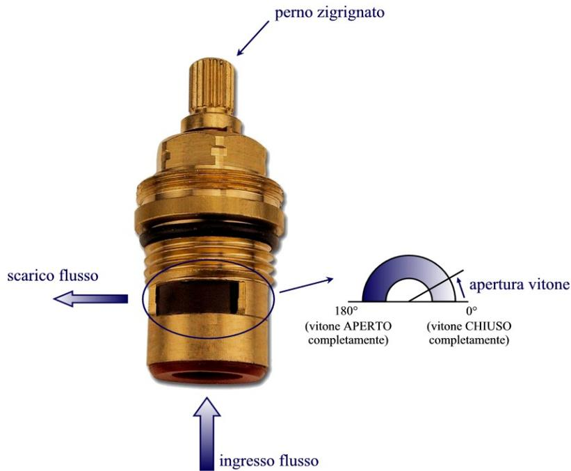
Figura 2.8: Schema funzionamento vitone
