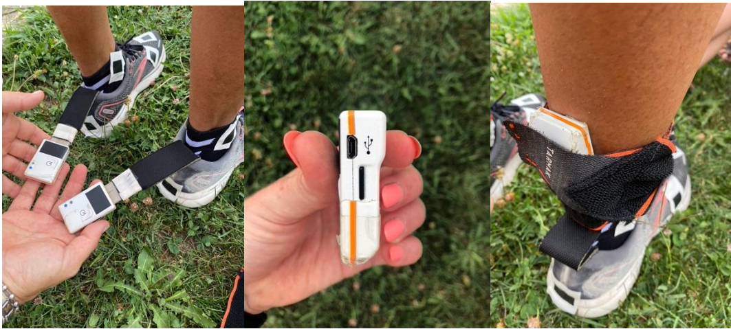
(Fig. 22) Solette BLU insole dall'azienda Sensor Medica®, con foto in dettaglio del lettore della scheda SD
