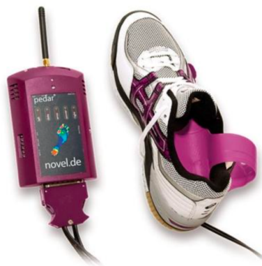
(Fig. 10) Soletta per la misurazione della pressione plantare by Pedar© Novel. [9]
