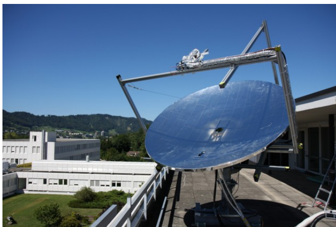
Figura 9.3: Prototipo di un sistema fotovoltaico ad alta concentrazione - laboratori IBM di Zurigo
