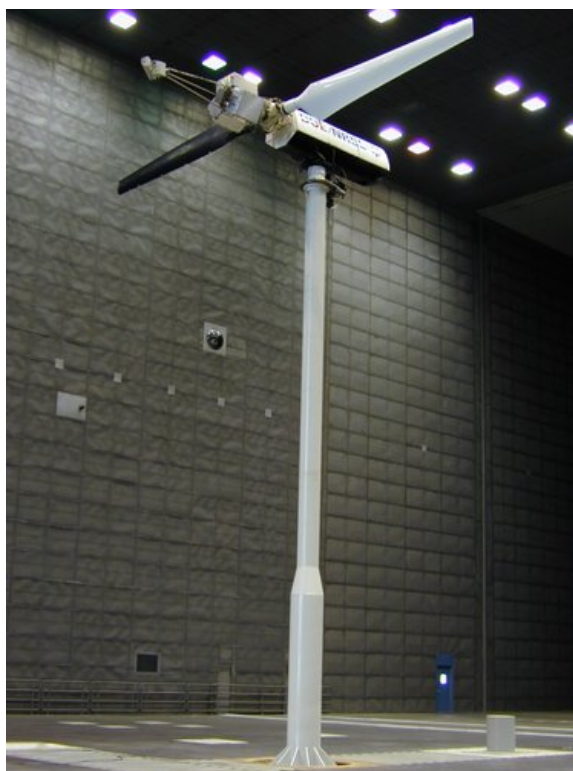
Figura 4.1: La configurazione della turbina eolica analizzata in galleria del vento.
