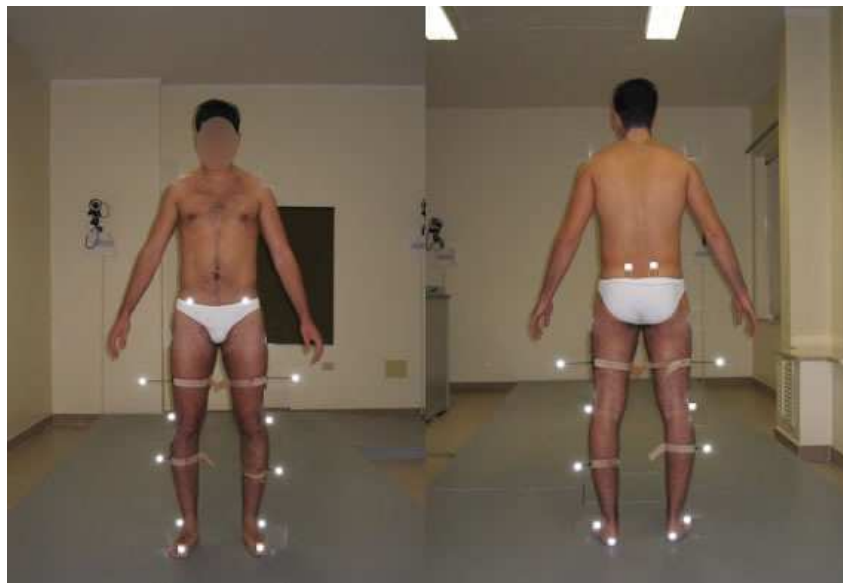
Fig.1.12 Disposizione dei markers secondo il protocollo Davis
