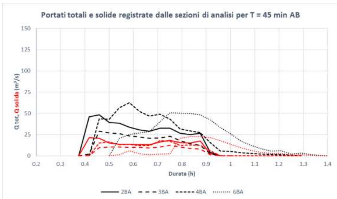
Figura 189. Confronto delle portate registrate dalle sezioni presenti all'interno del canale nella situazione ante – sistemazione AB per T = 45 min
