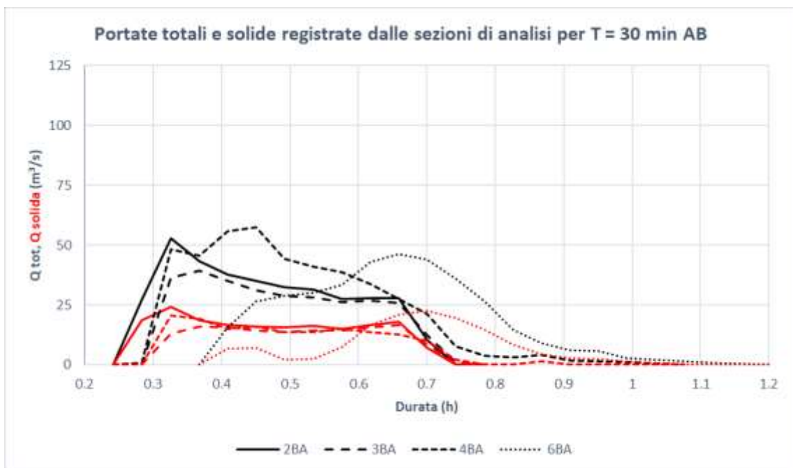
Figura 174. Confronto delle portate registrate dalle sezioni presenti all'interno del canale nella situazione ante – sistemazione AB per T = 30 min
