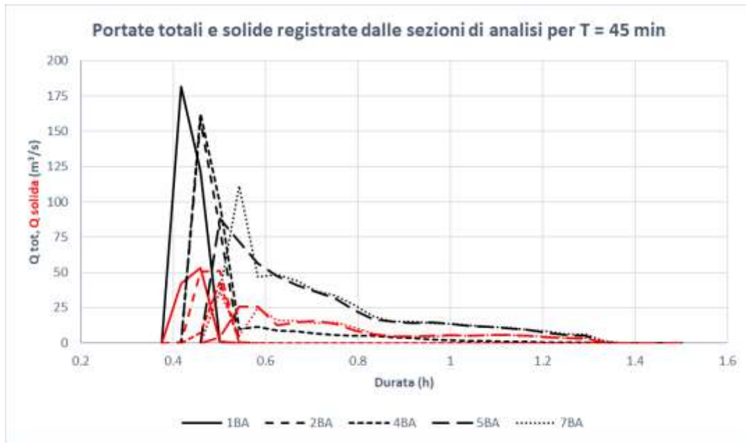
Figura 194. Confronto delle portate registrate dalle sezioni presenti all'interno del canale nella situazione post – sistemazione per T = 45 \text{ min}
