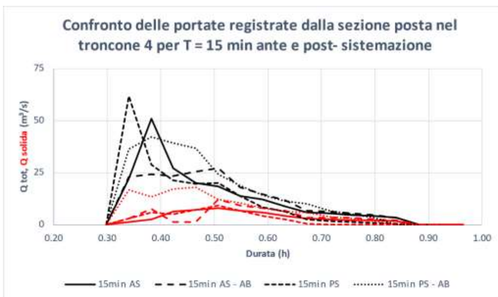
Figura 172. Confronto delle portate ante e post – sistemazione registrate dalle sezioni poste nel troncone 4
