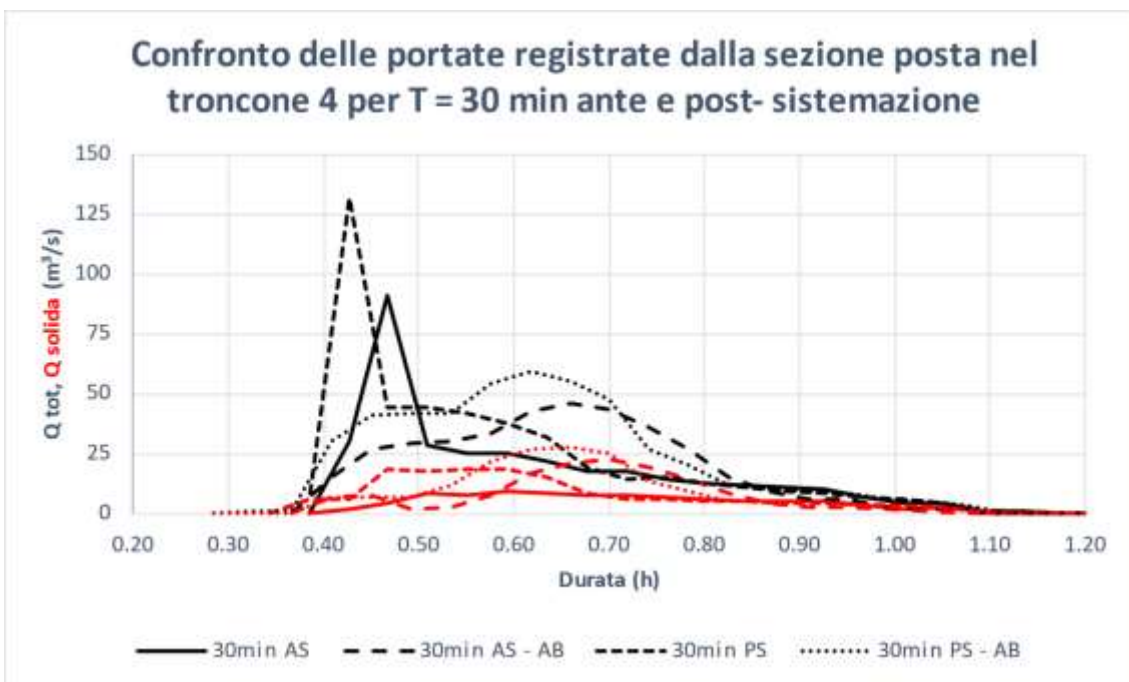
Figura 187. Confronto delle portate ante e post – sistemazione registrate dalle sezioni poste nel troncone 4 per T = 30 min
