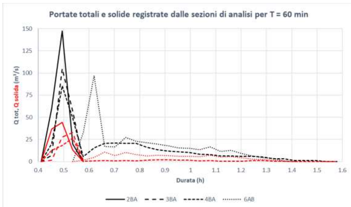
Figura 203. Confronto delle portate registrate dalle sezioni presenti all'interno del canale nella situazione ante – sistemazione per T = 60 min
