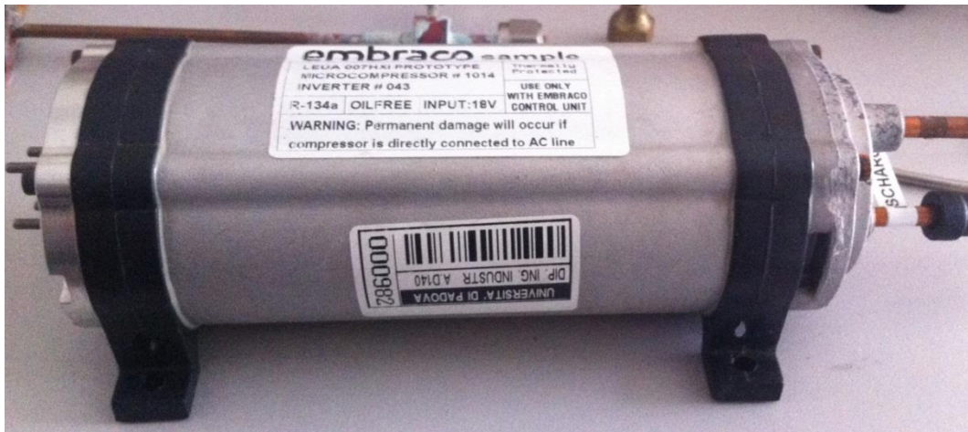
Figura 2.1. Compressore alternativo Embraco, privo di lubrificante, utilizzato per le sperimentazioni
