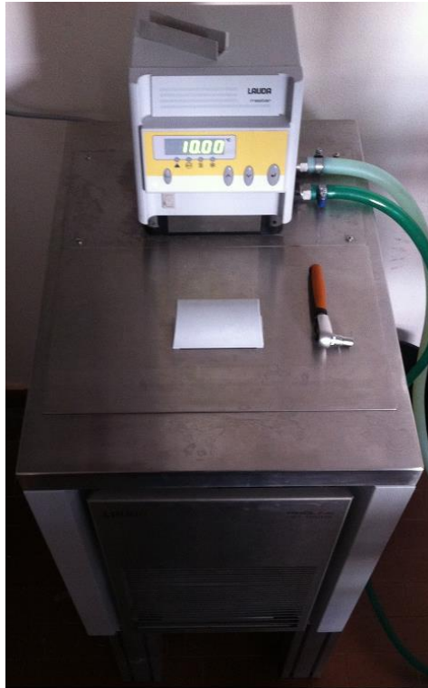
Figura 2.2. Bagno termostatico Lauda che controlla la temperatura del primo condensatore
