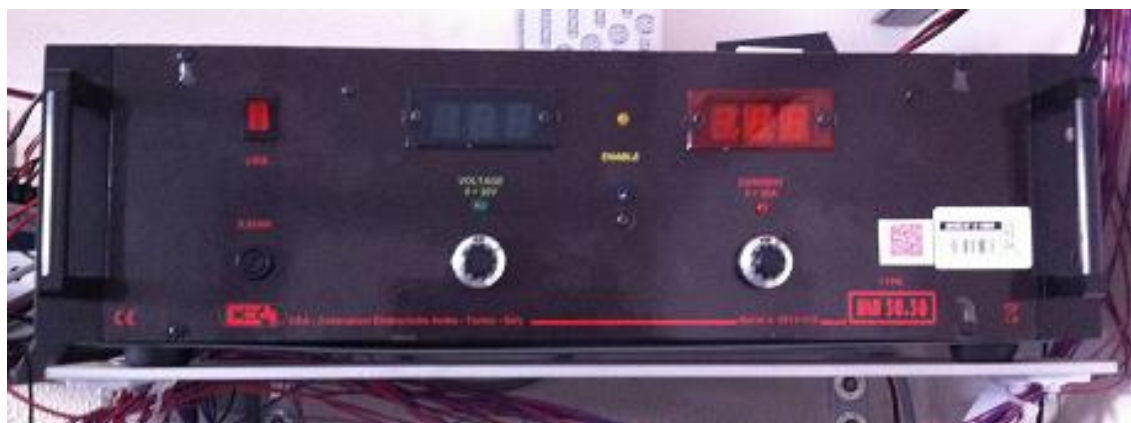
Figura 2.8. Generatore di corrente che alimenta la resistenza elettrica dell'evaporatore
