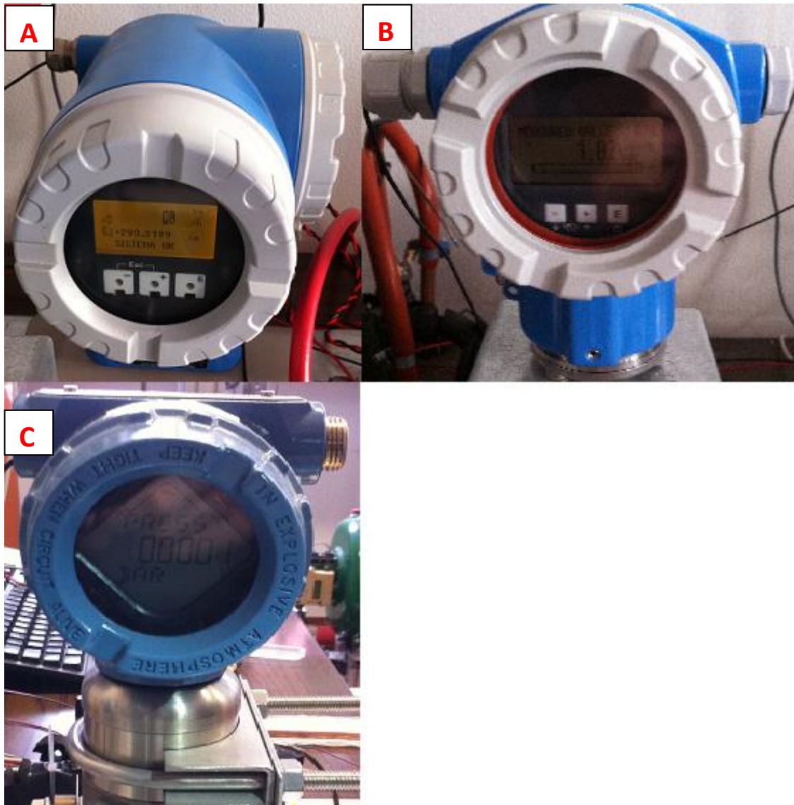
Figura 2.5. a) Misuratore di portata Coriolis; b) Trasduttore di pressione assoluta; c) Trasduttore differenziale di pressione
