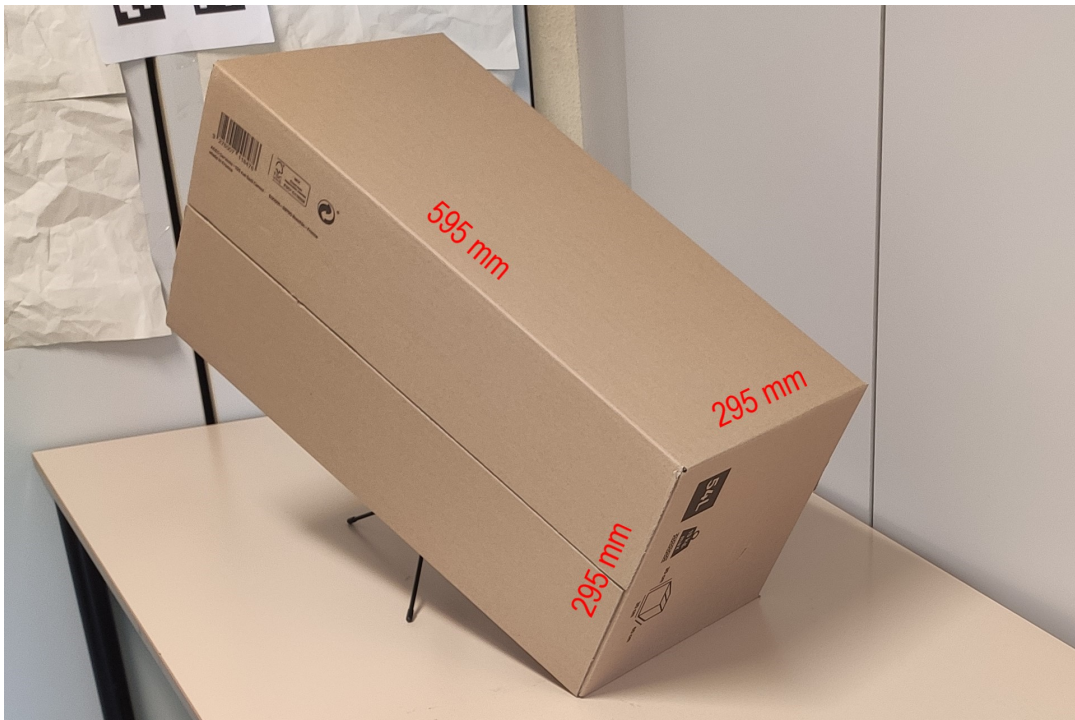
Figura 5-5: Bersaglio per la calibrazione estrinseca del sistema termocamera-LiDAR.
