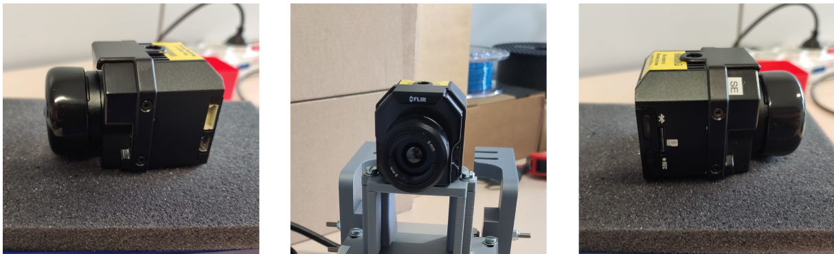
Figura 2-5: Termocamera FLIR Vue Pro R con ottica da 9 mm.
