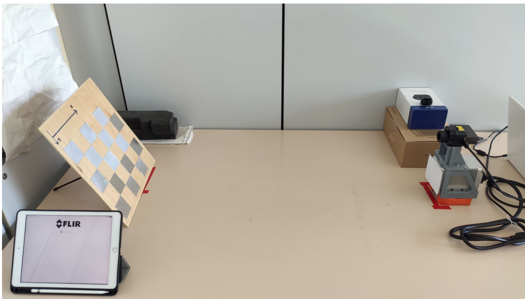
Figura 5-1: Setup per la calibrazione intrinseca della termocamera.
