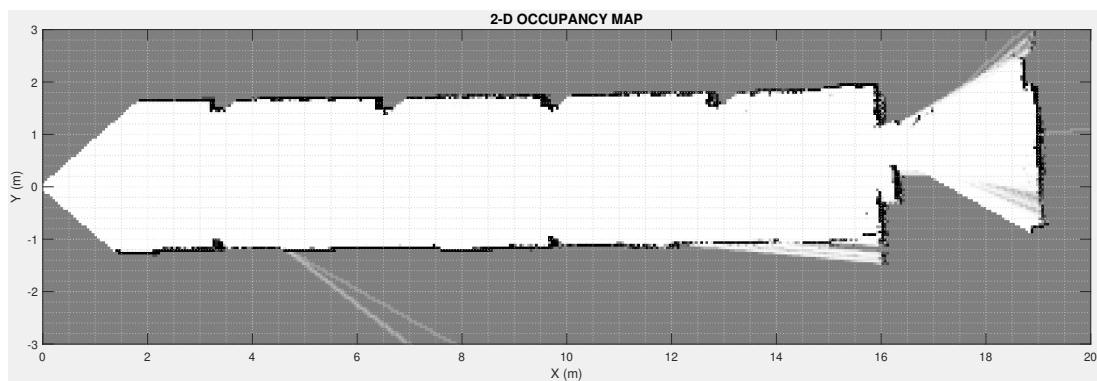
Figura 4-4: Esempio di occupancy map bidimensionale.
