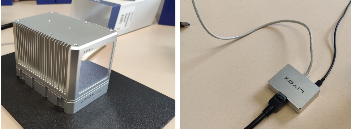
Figura 2-2: Livox Horizon (a sinistra) e unità Livox Converter (a destra).
