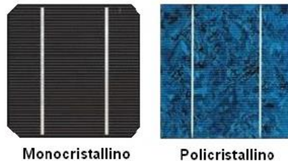
Figura 2-7 Pannelli fotovoltaici in Si monocristallino e policristallino
