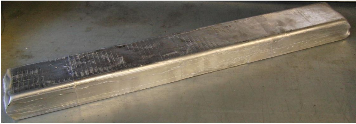
Figura 3.11: pane utilizzato per la realizzazione dei provini in EN AC 47100.
