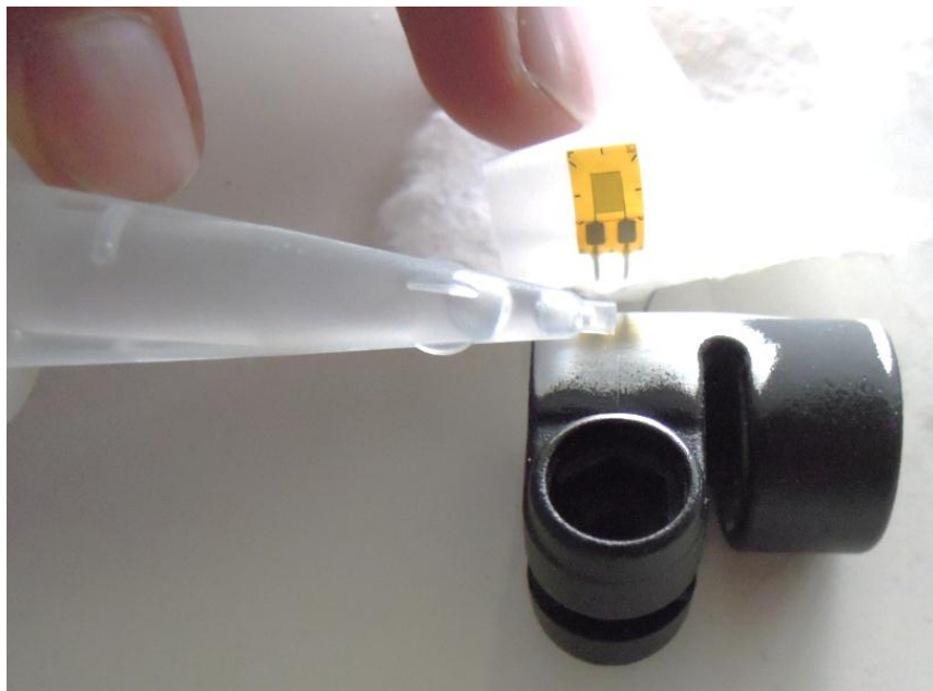
Figura 8.17: Applicazione del collante.
