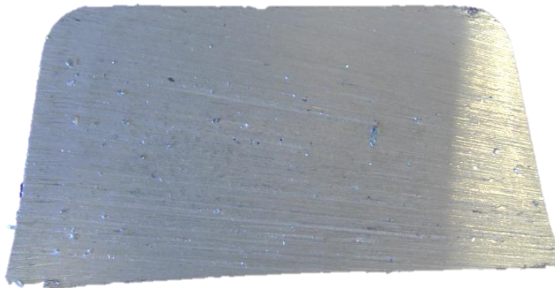
Figura 3.9: Sezione trapezoidale pane EN AC 47100.
