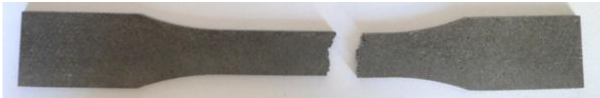
Figura 1.167: provino GAISi7 TT_1 dopo rottura
