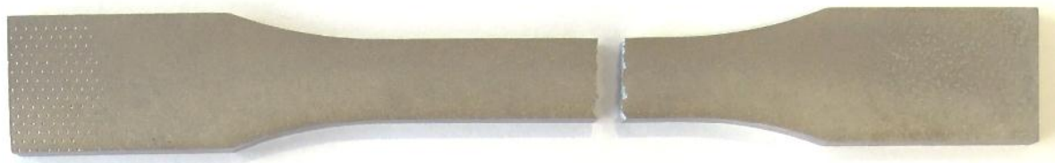
Figura 1.18: provino 46100_4 dopo rottura
