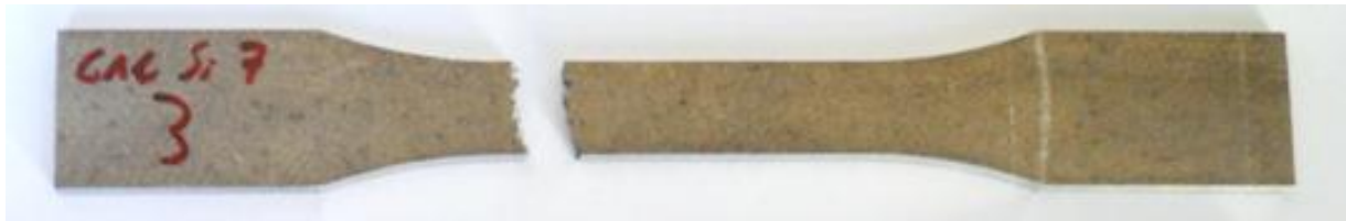
Figura 1.150: provino GAlSi7_3 dopo rottura
