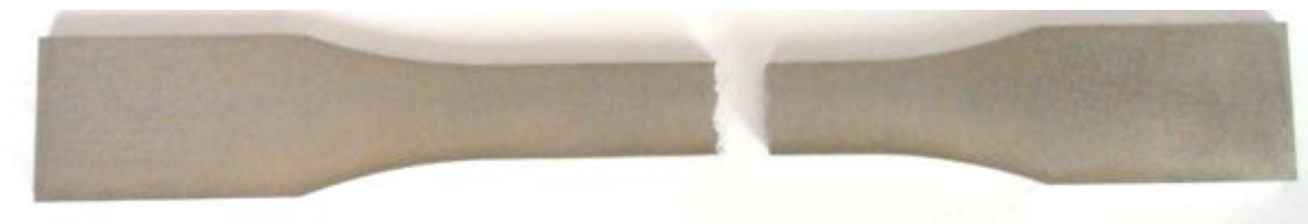
Figura 1.72: provino 44100_3 dopo rottura
