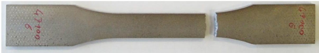
Figura 1.116: provino 47100_6 dopo rottura
