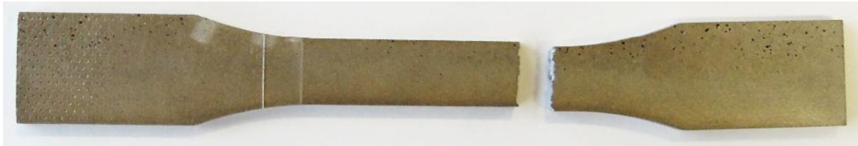
Figura 1.111: provino 47100_5 dopo rottura
