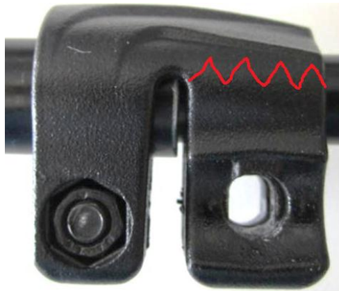
Figura 2.1: Sistema studiato. Particolare vista del manicotto. In Rosso viene evidenziata la zona più sollecitata.
