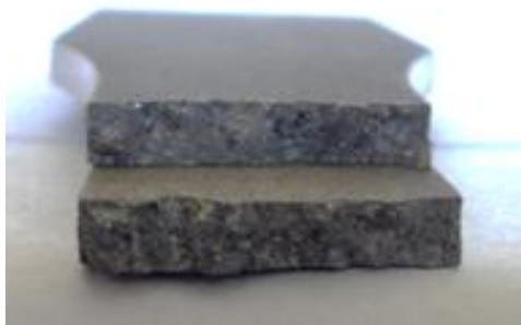
Figura 1.151: sezione di rottura provino GAlSi7_3
