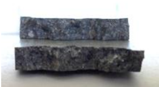
Figura 1.161: sezione di rottura provino GAISi7_5
