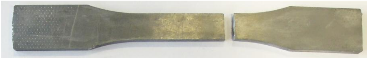
Figura 1.35: provino 46100P_2 dopo rottura
