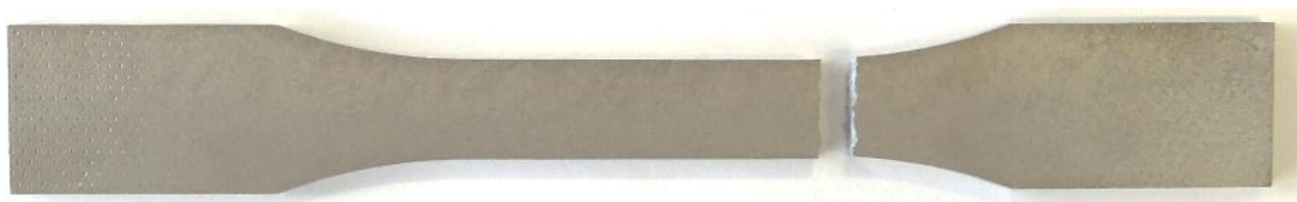
Figura 1.23: provino 46100_5 dopo rottura
