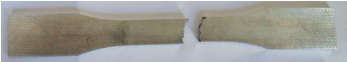
Figura 1.160: provino GAISi7_5 dopo rottura
