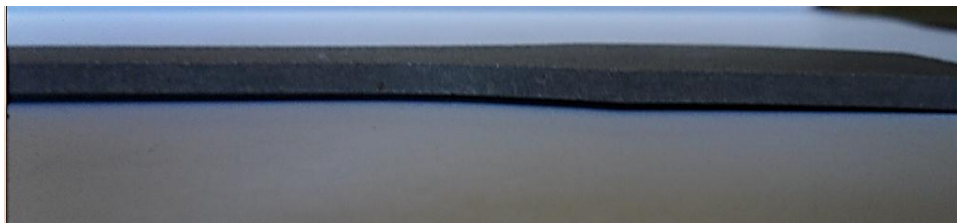
Figura 3.16: particolare dell'estremità di un provino in Lega GAlSi7 sottoposto a trattamento termico T6 seguito da invecchiamento.
