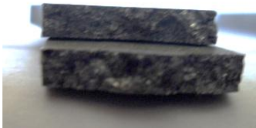
Figura 1.178: sezione di rottura provino GAlSi7 TT_4
