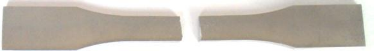
Figura 1.62: provino 44100_1 dopo rottura
