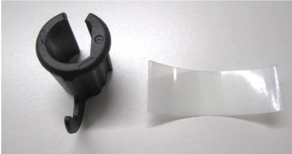
Figura 8.38: A sinistra viene mostrata la boccola ed a destra la lamina in Mylar.
