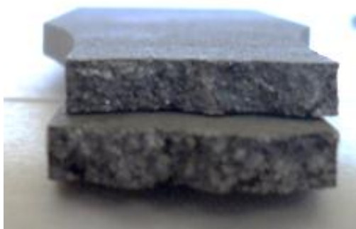
Figura 1.173: sezione di rottura provino GAISi7 TT_3
