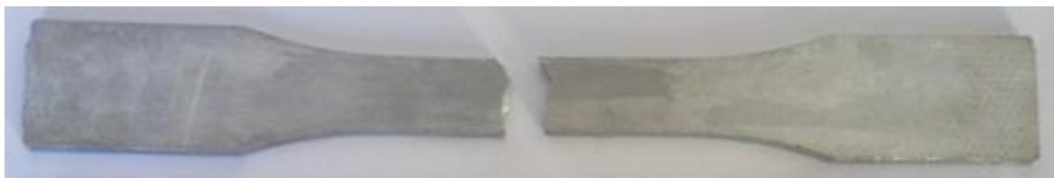
Figura 1.123: provino 47100P_1 dopo rottura
