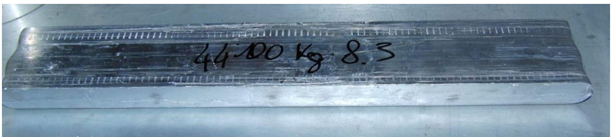
Figura 3.10: pane utilizzato per la realizzazione dei provini in EN AC 44100.
