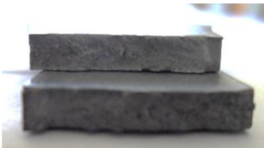
Figura 1.139: sezione di rottura provino 47100P_4
