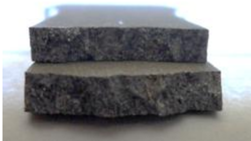
Figura 1.156: sezione di rottura provino GAlSi7_4
