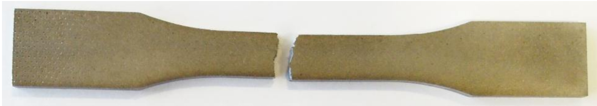
Figura 1.106: provino 47100_4 dopo rottura
