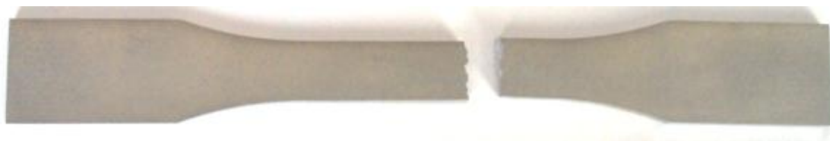
Figura 1.67: provino 44100_2 dopo rottura
