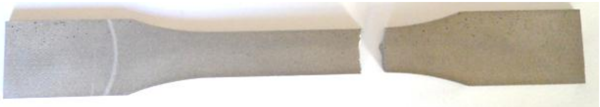
Figura 1.101: provino 47100_3 dopo rottura
