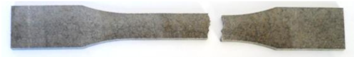
Figura 1.172: provino GAISi7 TT_3 dopo rottura
