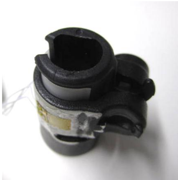
Figura 8.51: Spessore in Mylar inserito tra boccola e manicotto.
