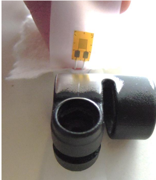
Figura 8.16: Posizionamento dell'estensimetro in corrispondenza del lembo del manicotto
