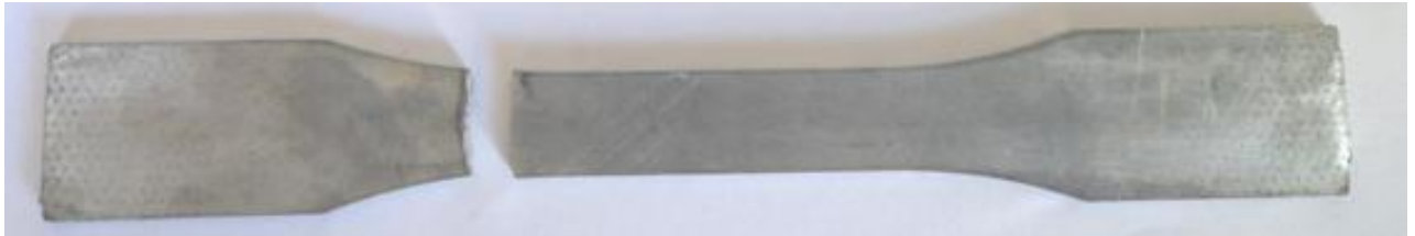
Figura 1.143: provino 47100P_7 dopo rottura
