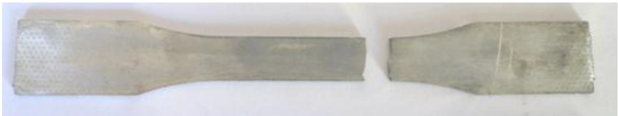
Figura 1.133: provino 47100P_3 dopo rottura
