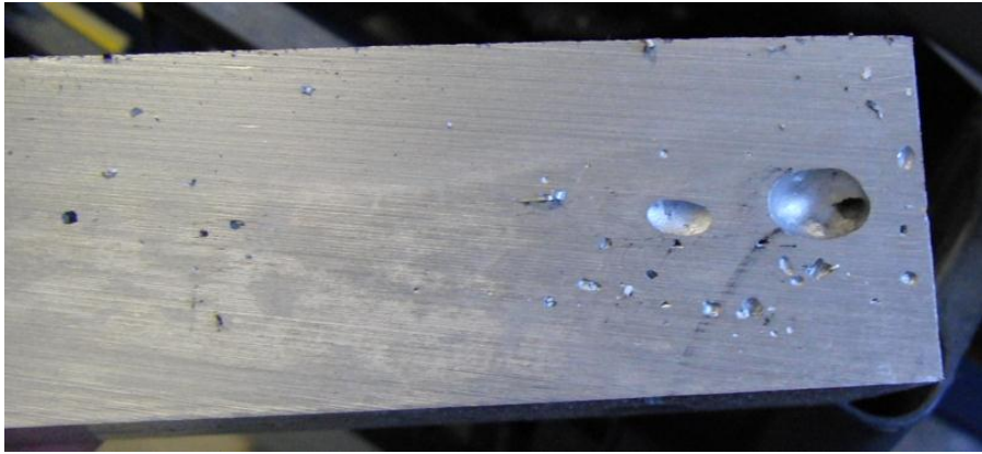
Figura 3.13: Soffiature presenti all'interno del pane di fonderia del materiale EN AC 44100.
