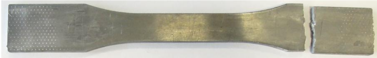
Figura 1.40: provino 46100P_6 dopo rottura
