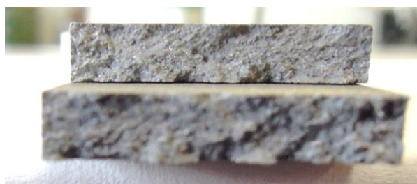
Figura 1.24: sezione di rottura provino 46100_5
