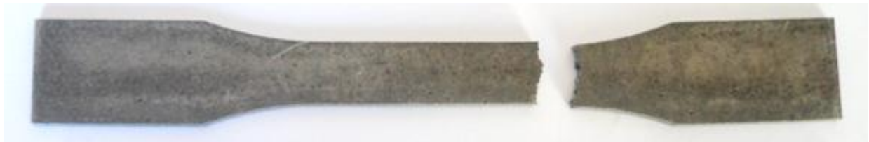
Figura 1.177: provino GAlSi7 TT_4 dopo rottura
