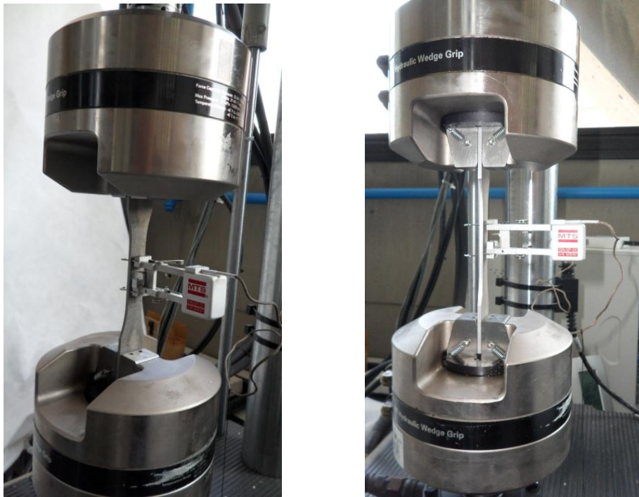
Figura 3.22: provino in posizione per eseguire la prova di trazione.
