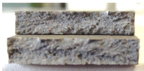
Figura 1.19: sezione di rottura provino 46100_4
