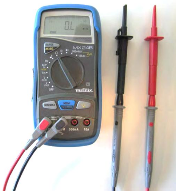
Figura 8.19: Multimetro per la misurazione della resistenza dell'estensimetro.
