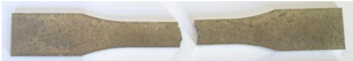
Figura 1.155: provino GAlSi7_4 dopo rottura
