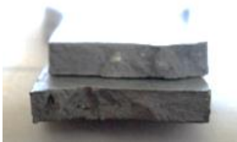
Figura 1.124: sezione di rottura provino 47100P_1
