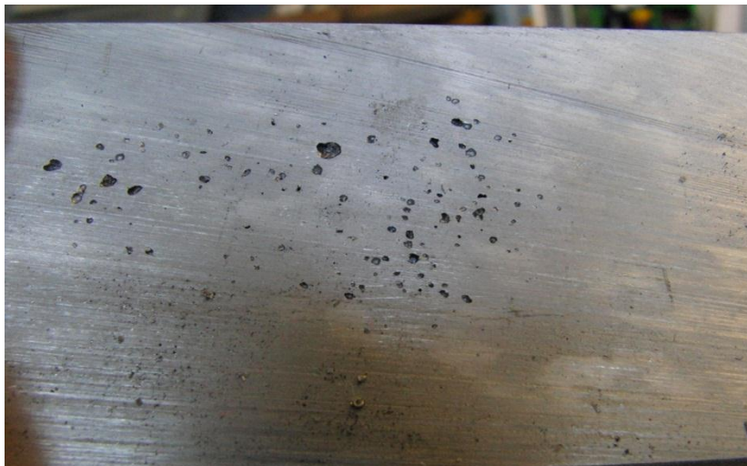
Figura 3.12: Soffiature presenti all'interno del pane di fonderia del materiale EN AC 46100.
