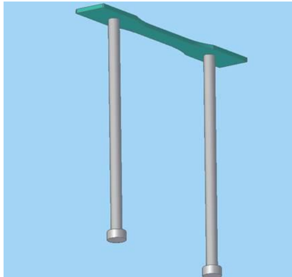
Figura 3.19: Posizionamento e forma degli estrattori.
