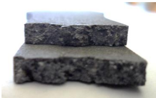
Figura 1.168: sezione di rottura provino GAISi7 TT_
