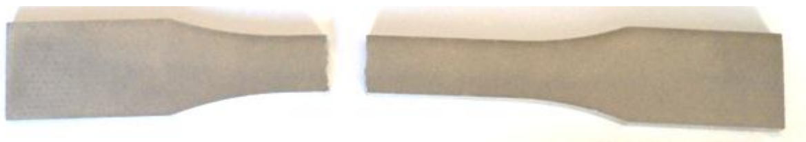
Figura 1.96: provino 47100_1 dopo rottura
