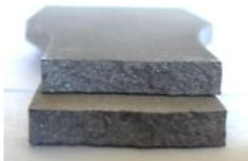
Figura 1.97: sezione di rottura provino 47100_1
