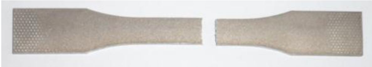
Figura 1.3: provino 46100_1 dopo rottura
