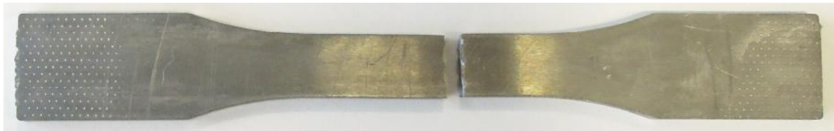
Figura 1.45: provino 46100P_7 dopo rottura
