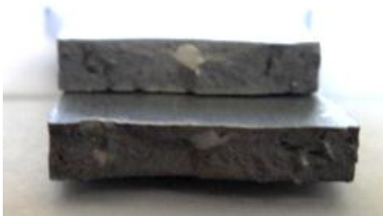
Figura 1.134: sezione di rottura provino 47100P_3
