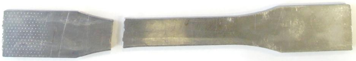
Figura 1.55: provino 46100P_9 dopo rottura
