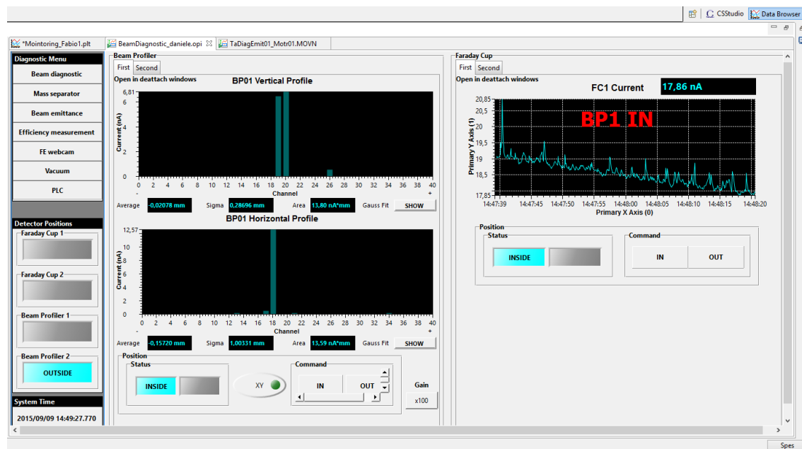
Fig. 4.5: Schermata dell'interfaccia operatore per il controllo e la visualizzazione del beam profiler (a sinistra) e della faraday cup (a destra).
