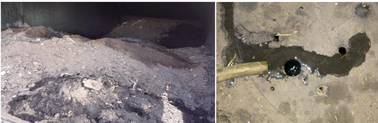
FIGURA 7.2 : CENERI RESIDUE E REFLUI DI CONSISTENZA OLEOSA E ODORE DI AMMONIACA
