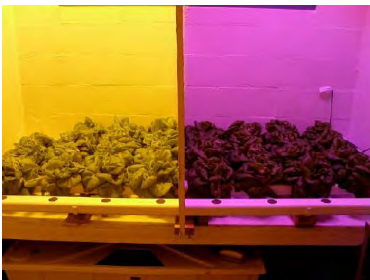
Figura 18: Camera di coltivazione con sistema idroponico, lampade HPS a sinistra e luci LED a destra
