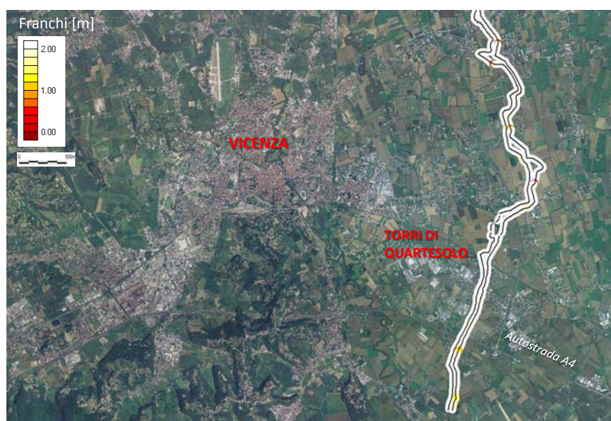
Figura 6.42: Franchi arginali nel terzo tratto (2012).
