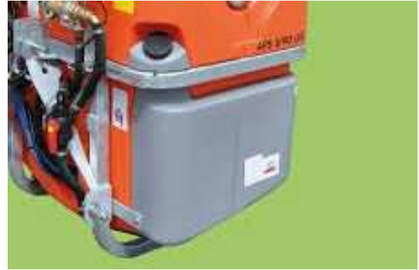
Fig. 2.4 lochmann.com serbatoio lavamacchina
