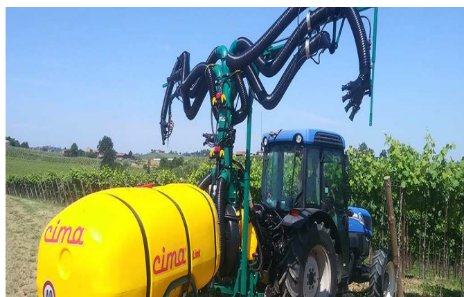
(Fig. 1.5) Cima.it atomizzatore aeroassistito a frantumazione
