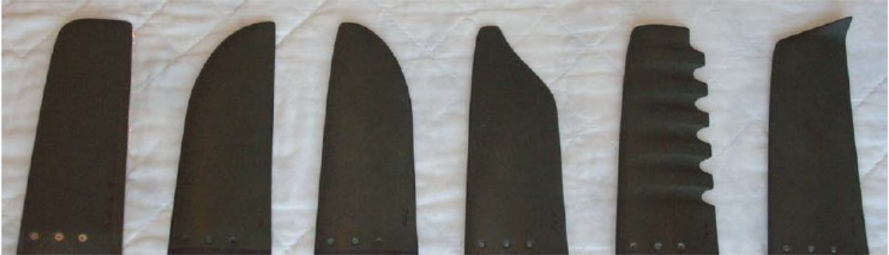
Fig. 11 Geometrie di estremità testate in galleria del vento [15]
