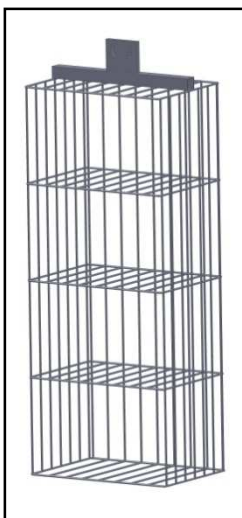
Figura 1.11 – Cesta a quattro ripiani per convogliatore aereo monorotaia
